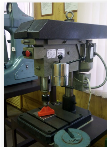
Экспериментальная установка для определения интенсивности изнашивания образцов (п.16)
