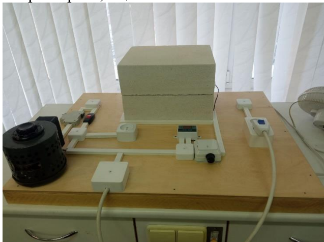
Рисунок 12 – Фото экспериментальной установки для ускоренного термического состаривания кабельных изделий
