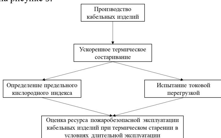
Рисунок 9 – Предлагаемый научно обоснованный подход к определению ресурса пожаробезопасной эксплуатации кабельных изделий при термическом старении в условиях длительной эксплуатации
