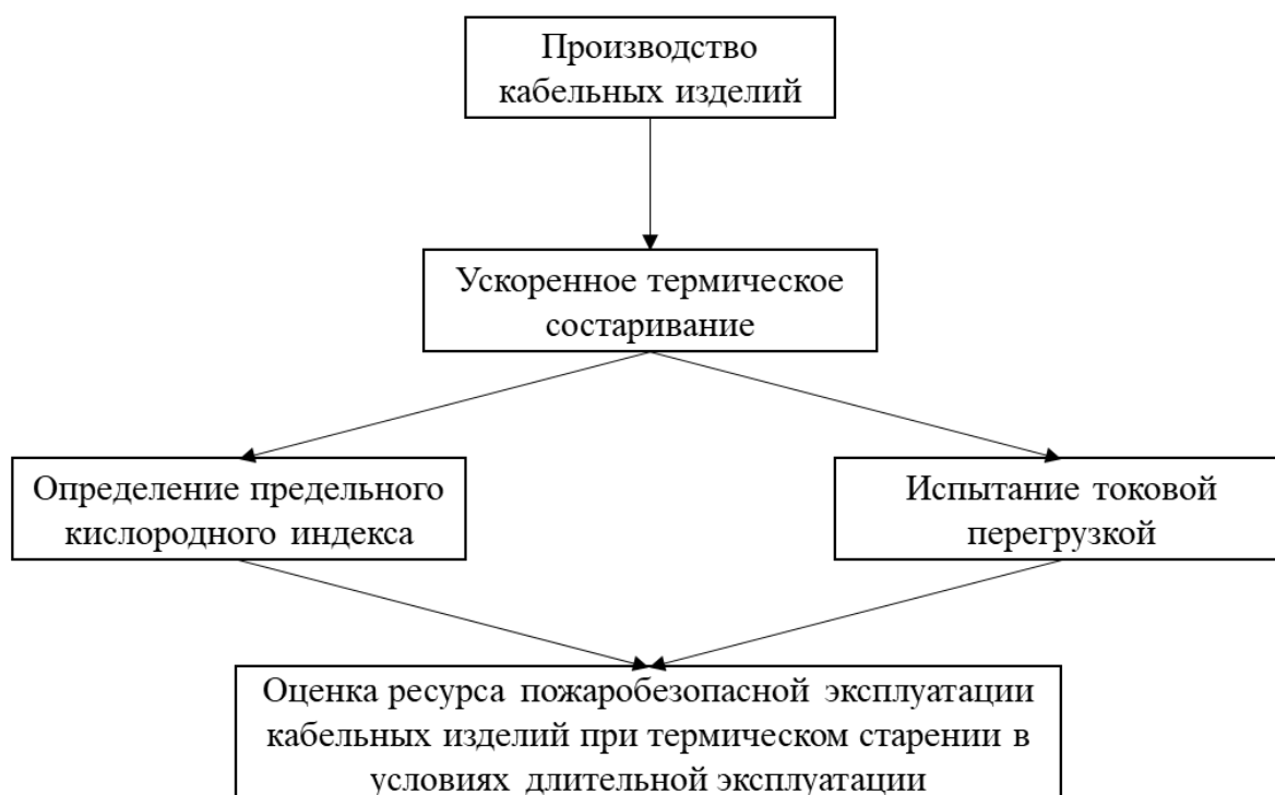
Рисунок 3.28 – Предлагаемый научно обоснованный подход к определению ресурса пожаробезопасной эксплуатации кабельных изделий при термическом старении в условиях длительной эксплуатации
