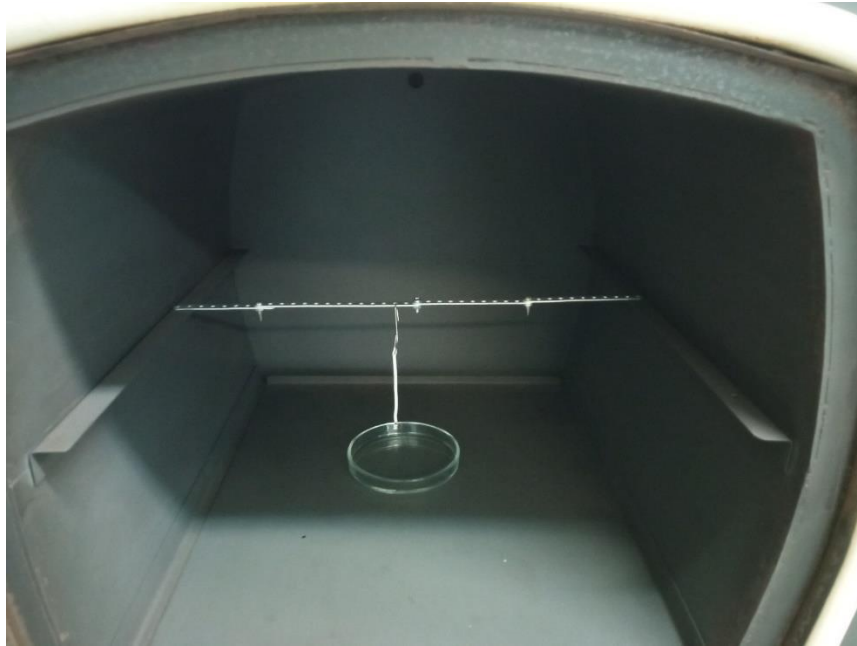
Рисунок 2.1 – Система крепления образцов в сушильном шкафу Тула-Терм СНВС-4,5.4,5.4/3-И1
