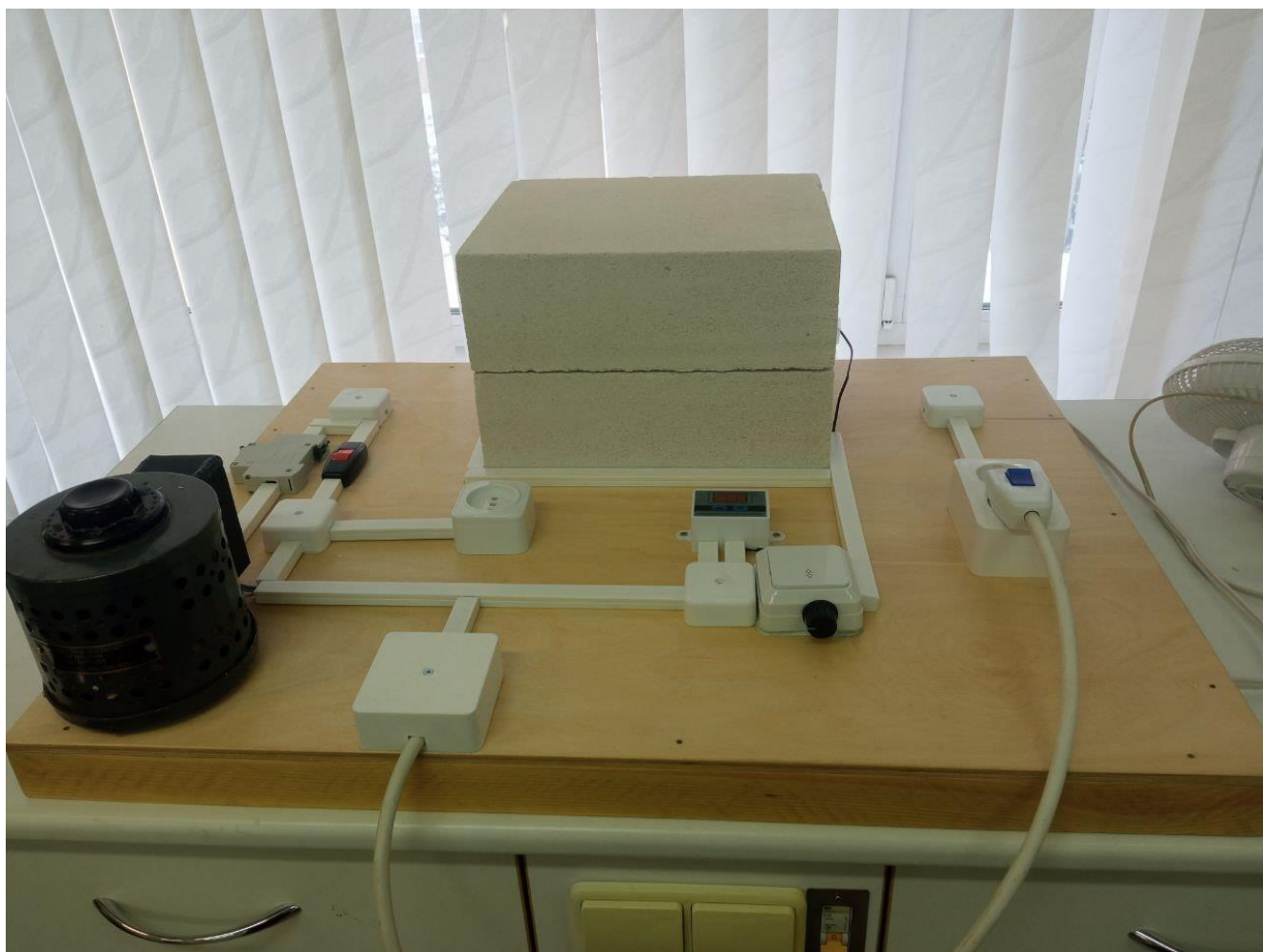
Рисунок 3.32 – Фото экспериментальной установки для ускоренного термического состаривания кабельных изделий
