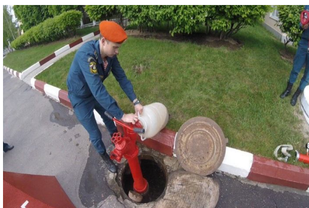
Рис. 2. Определение расхода отношением объема вылившейся жидкости к времени за которое наполнился емкость
