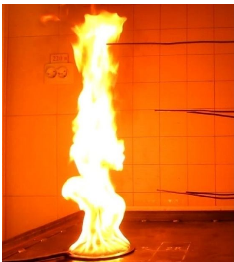
Рис. 6. Горение пролива бензина АИ-92 в модельном очаге d=15\text{ см}^2
