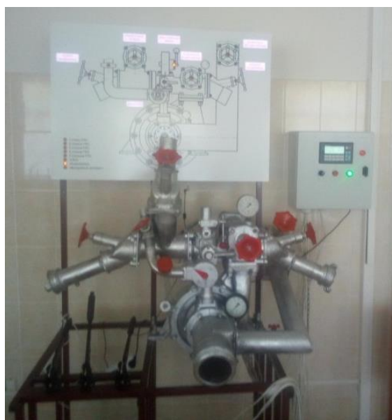
Рис. 4. Тренажер «Пожарный насос»
