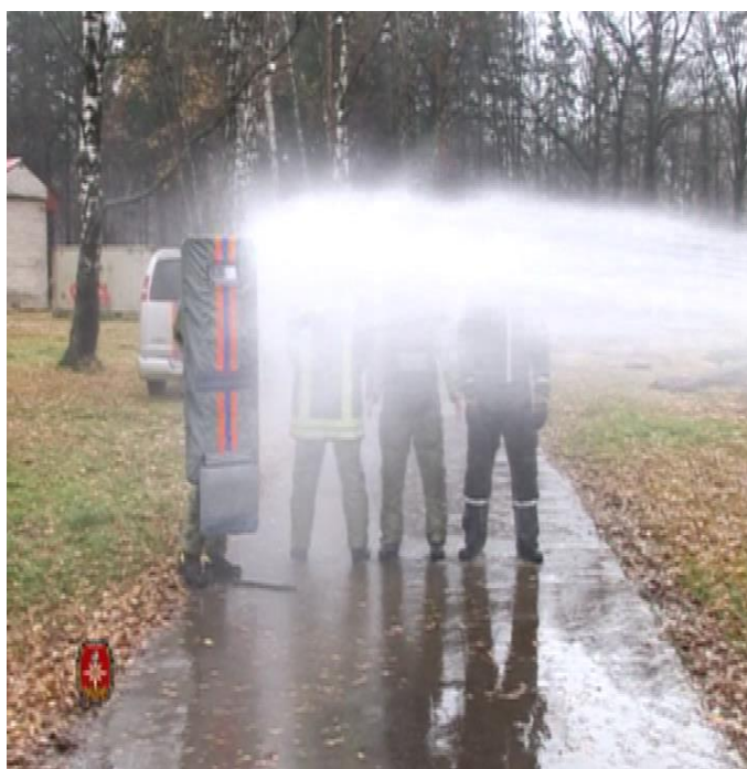
Рис. 5. При тушении пожаров средства защиты намокают и значительно увеличивают в весе
