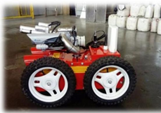
Рис. 1. Пожарный робот МРУП 112 ВР
