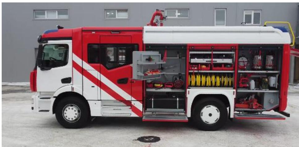
**Рис. 3.** Размещение пожарно-технического оборудования в отсеках пожарного автомобиля
