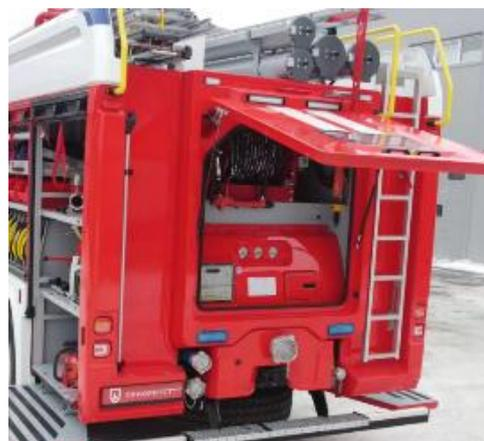
**Рис. 2.** Общий вид насосного отсека пожарного автомобиля
