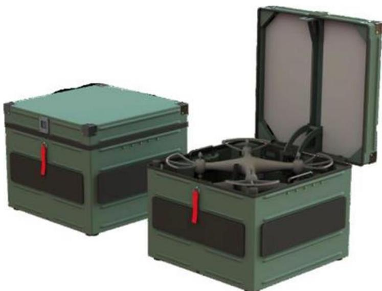
**Рис. 1.** Внешний вид возможного исполнения модулей кассетного запуска беспилотных летательных аппаратов с борта наземного робототехнического комплекса среднего и тяжелых классов
