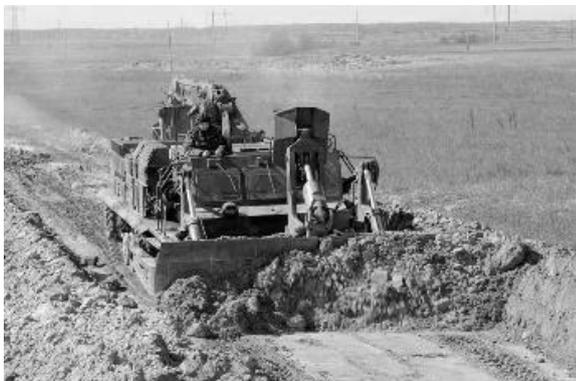
**Рис.3.** Бульдозер БАТ-2 в работе
