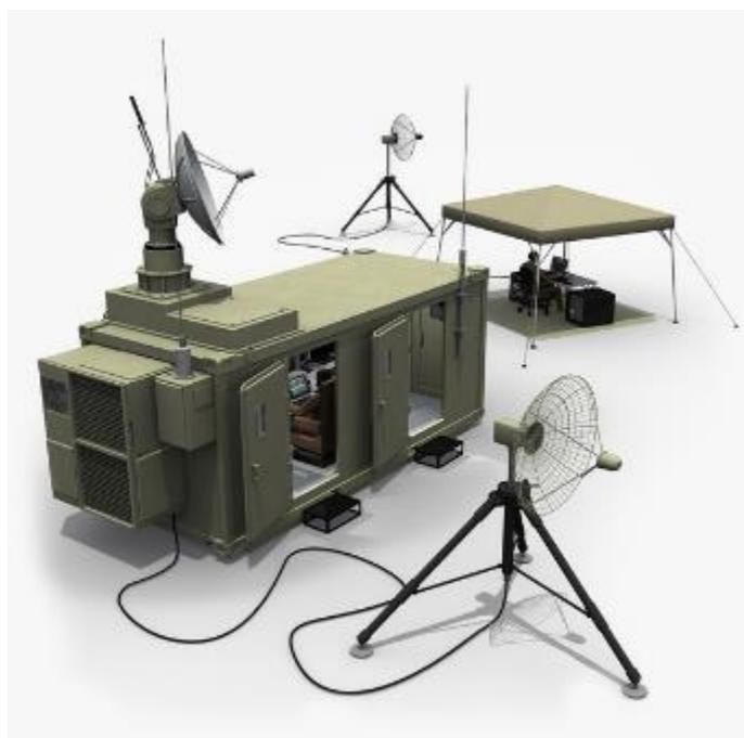
**Рис. 2.** Примерный вид передвижного пункта управления БАС
