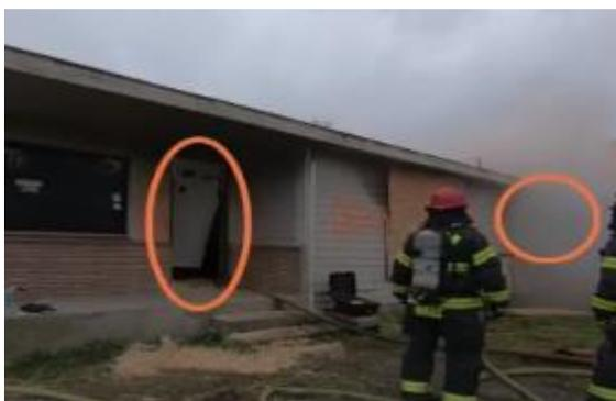
Рис. 1. Приточный и вытяжной проемы
