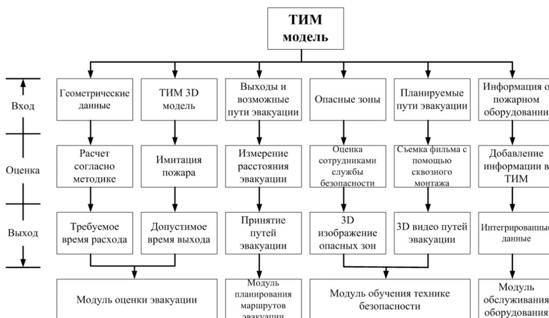
**Рисунок.** Структура модели с применением возможностей ТИМ для управления пожарной безопасностью
