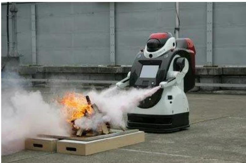
**Рис.1.** Пожарный робот с искусственным интеллектом
