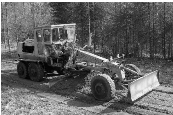
**Рис. 1.** Автогрейдер ДЗ-98 прокладывает минерализованную полосу
