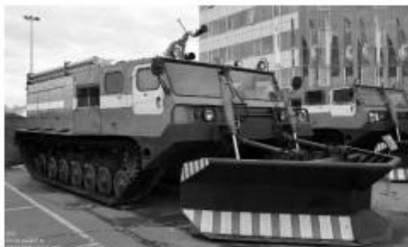
**Рис. 4.** Гусеничная пожарная машина «Огнеборец»
