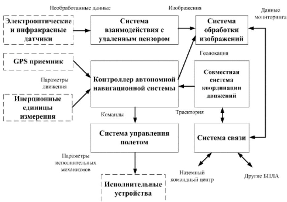
Рис. 1. Общая структура используемых БПЛА
