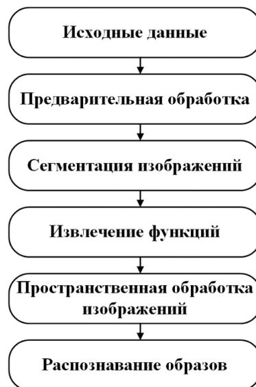
**Рисунок.** Блок-схема системы обнаружения пожара на основе обработки изображений
