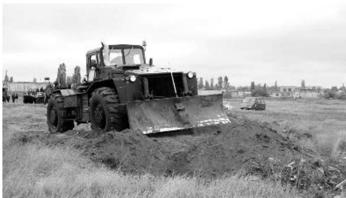
**Рис. 2.** Бульдозер БКТ-рк2 прокладывает опорную минерализованную полосу
