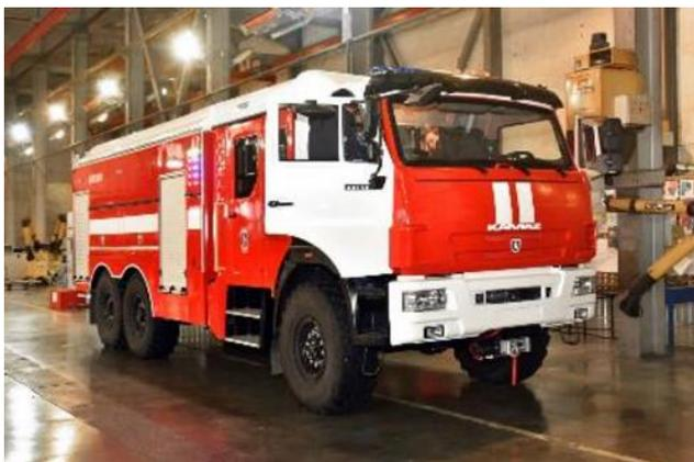
**Рис. 1.** Пожарная автоцистерна АЦ-СОР 2,0-20:10 (КамАЗ-43118)-341ВР «ГЕФЕСТ»
