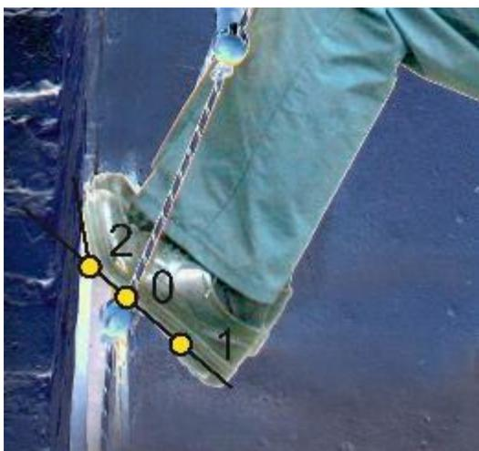
**Рис. 4.** Отрезок опорного расстояния на стопе при спуске по навесной лестнице
