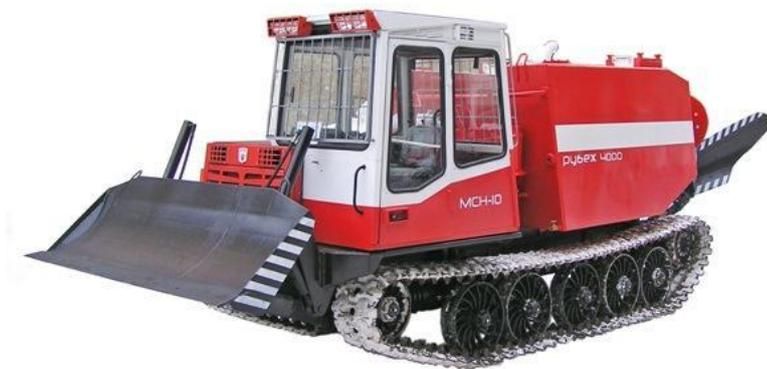
**Рис. 1.** Лесопожарный трактор МСН-10 ПМ «Рубеж 4000»
