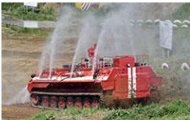
**Рис. 2.** Пожарная машина МТ-ЛБу-ГПМ-10
