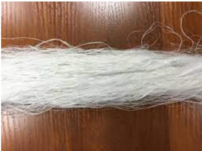
**Рис. 1.** Сверхвысокомолекулярный полиэтилен
