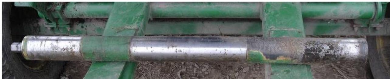
**Рис. 3.** Валик ременного перебора в сборе
