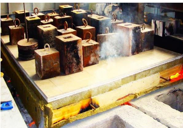
**Рис. 2.** Испытание панели перекрытия на основе ДПК
