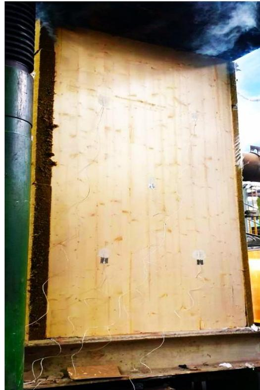
**Рис. 1.** Испытание стеновой панели на основе ДПК
