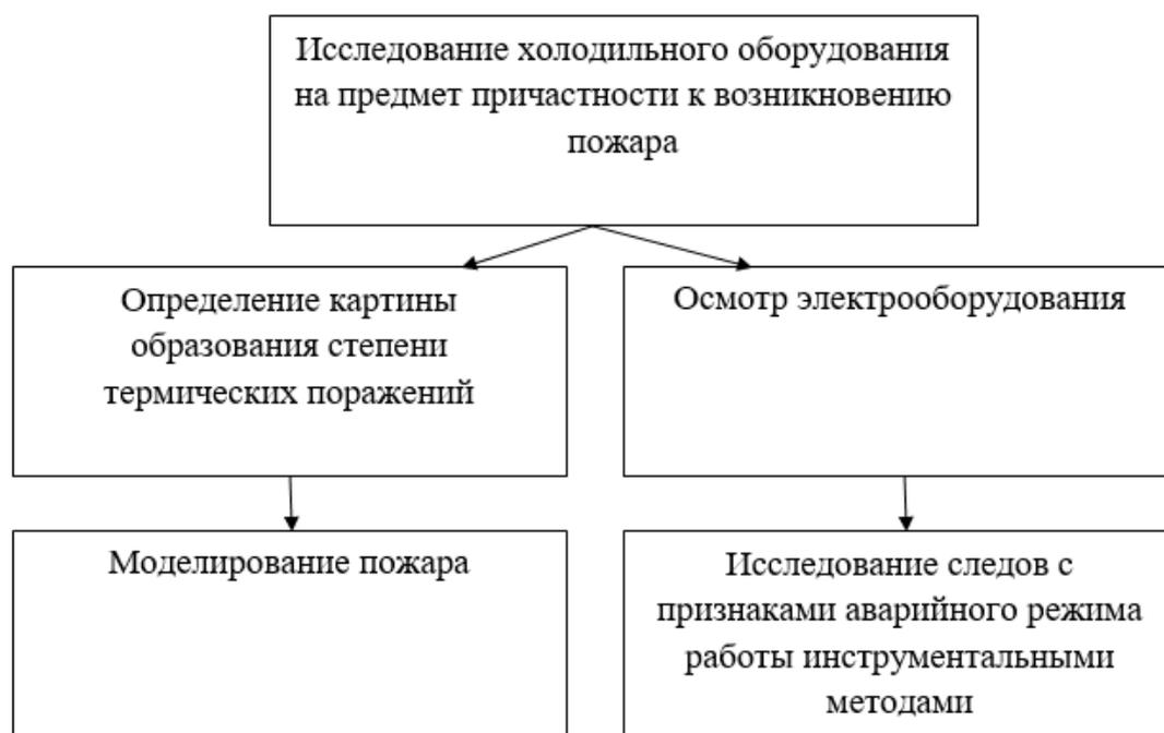
**Рисунок.** Алгоритм действий по отработке версии причастности холодильного оборудования к возникновению пожара
