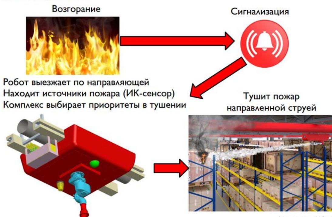
Рис. 4. Принцип работы системы автоматического тушения пожаров в зданиях «KRAKEN»
