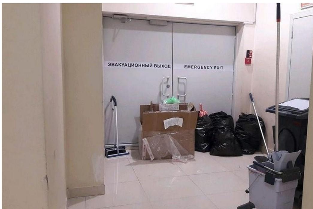
**Рисунок.** Загромождение эвакуационного выхода
