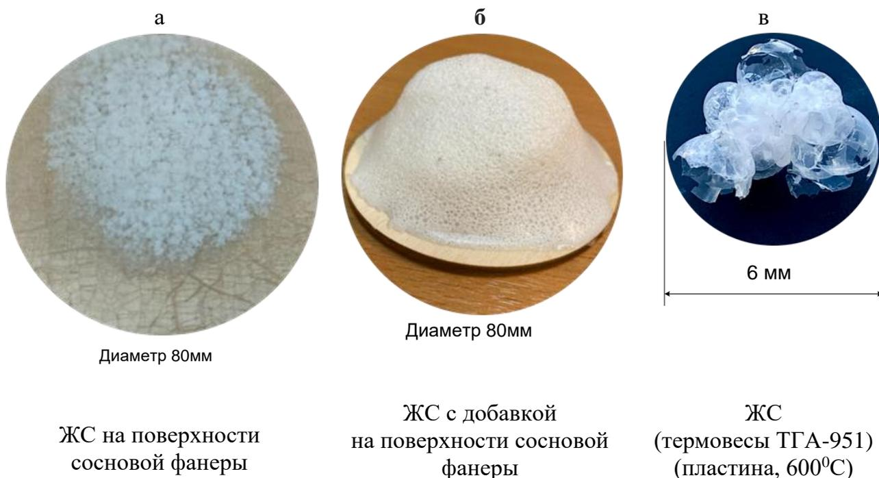
Рис 2. Внешний образцов жидкого стекла после нагревания
