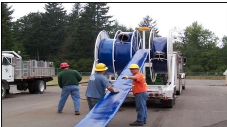
**Рис. 6.** Процесс разворачивания МТС из бухты
