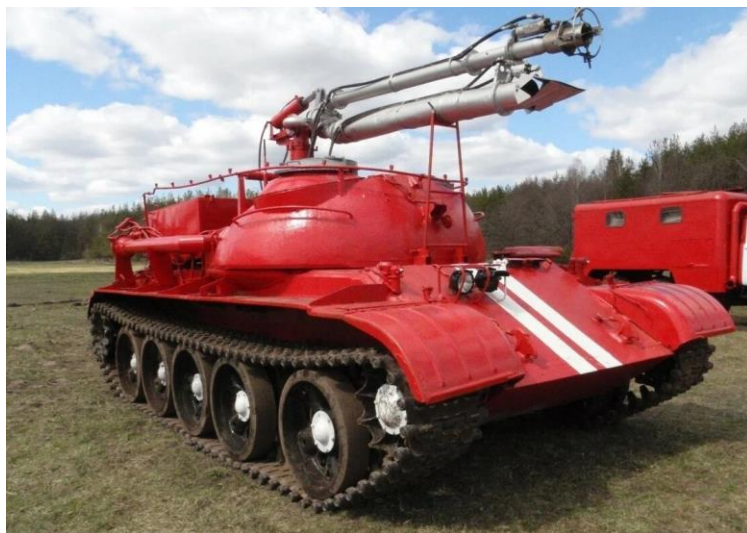
Рисунок. Роботизированный самоходный лафетный ствол (СЛС-100) «Сойка»
