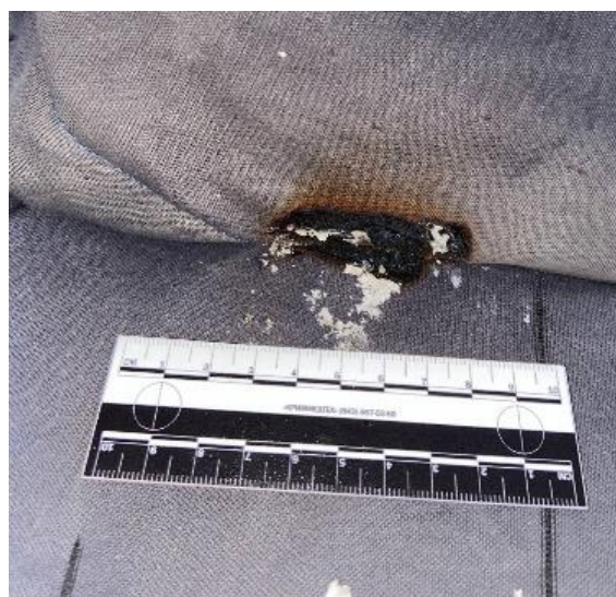
Рис. 2. Образец материала «Полиэстер» после удаления ТТИ
