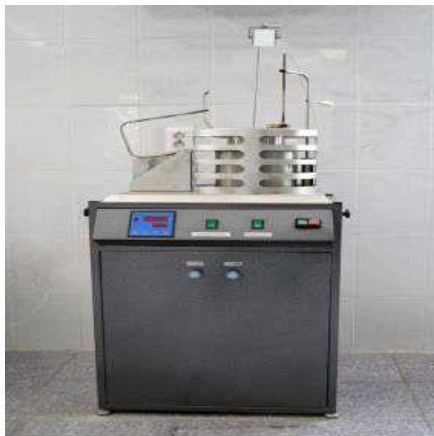
Рис. 1. Установка для определения температуры воспламенения и самовоспламенения твердых веществ и материалов «ОТП»
