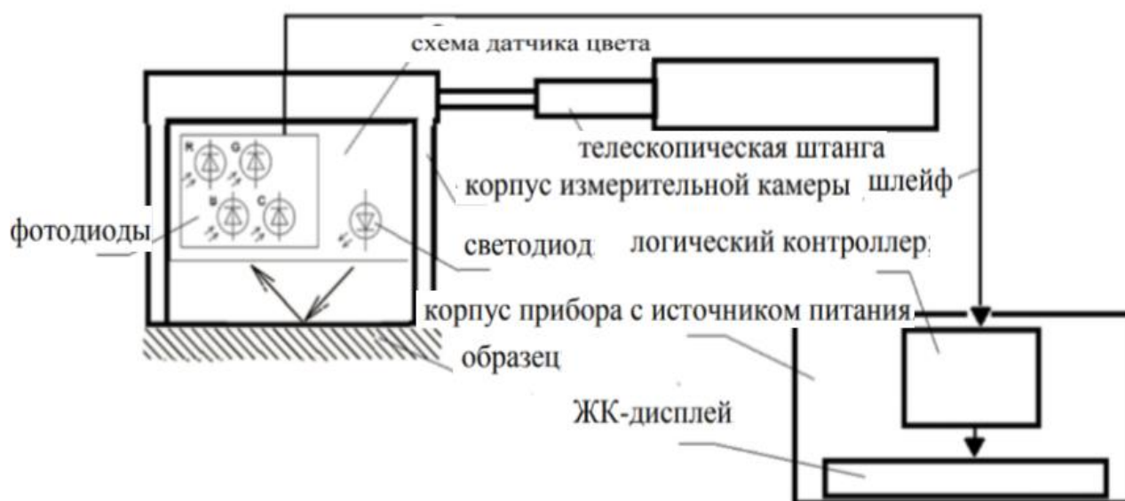
Рис. 1. Прибор для контроля степени термических повреждений в работе [1]
