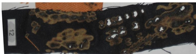
Рис. 4. Зависимость интенсивности излучения, вызывающей повреждение ткани, от длительности воздействия излучения (а) и внешний вид ткани после опытов (б)
