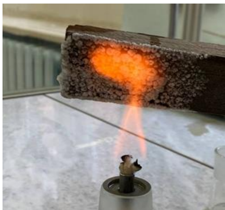
Рис. 1. Горение необработанной древесины от источника зажигания (а), без источника пламени (б)
