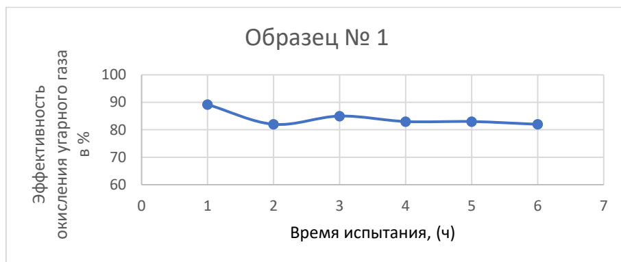
Рис. 1. Эффективность палладиевого катализатора, образец № 1, с предварительно заполненной пористой структурой дистиллированной водой на 40 % (объем угарного газа 100 мл).
