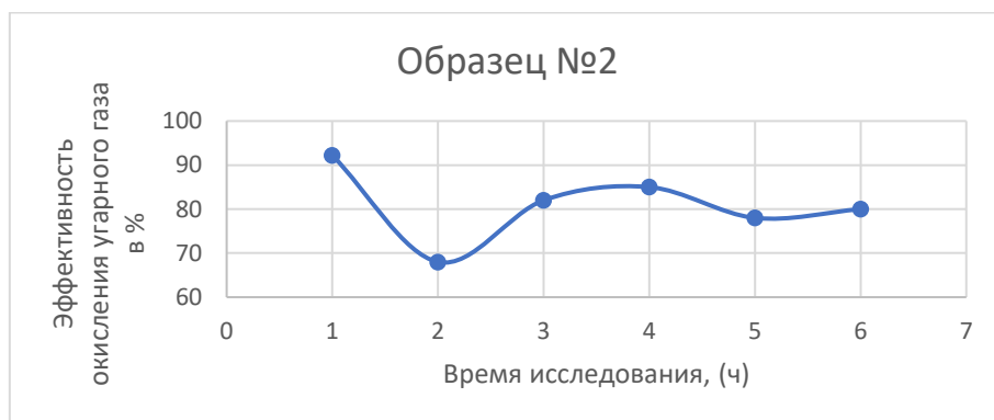
Рис. 2. Эффективность палладиевого катализатора, образец № 2, с предварительно заполненной пористой структурой дистиллированной водой на 60 % (объем угарного газа 100 мл)
