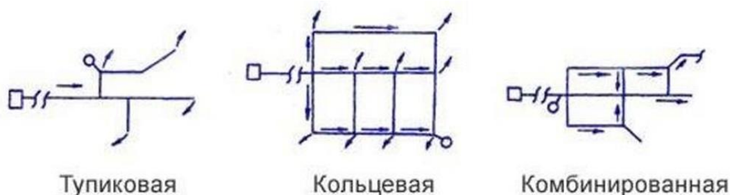
Рис. 1. Схемы систем водоснабжения
