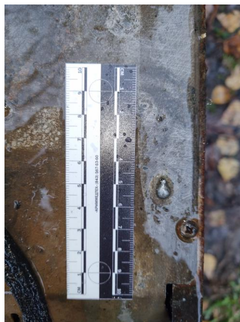
Рис. 2. Капля расплавленного металла со следами стекания вниз на задней стенке холодильника
