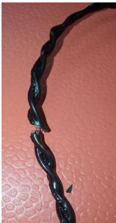
Рис. 1. Внешний вид образца № 1 после состаривания и воздействия токовой перегрузки
