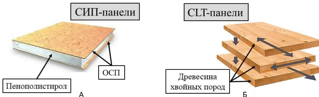
Рис. 1. СИП-панели (А) и CLT-панели (Б)
