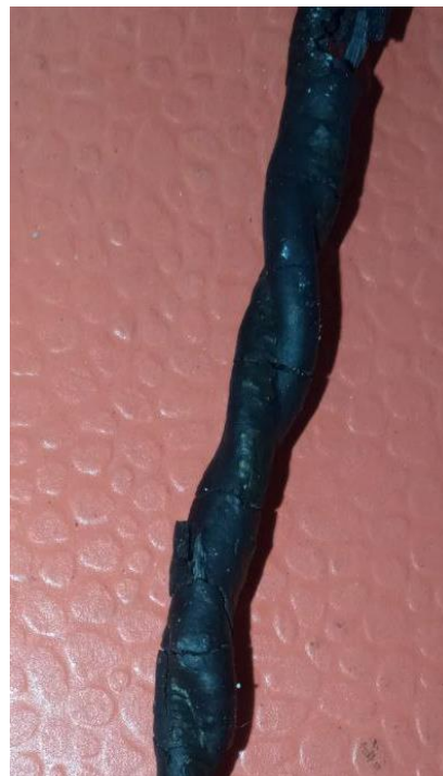
Рис. 2. Внешний вид образца № 2 после состаривания и воздействия токовой перегрузки
