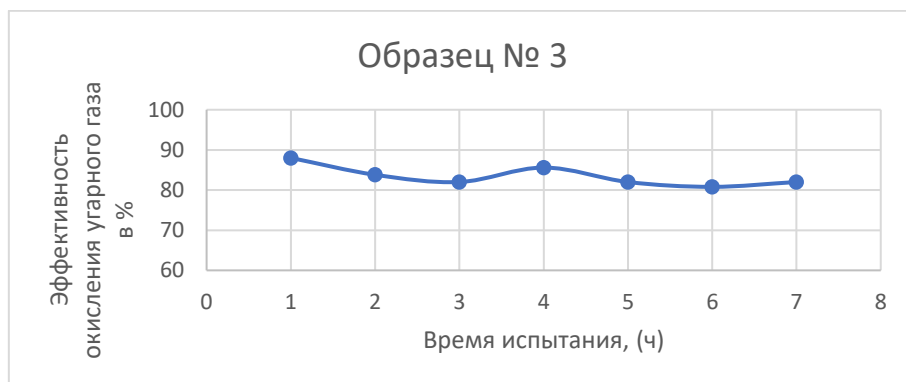
Рис. 3. Эффективность палладиевого катализатора, образец № 3, с предварительно заполненной пористой структурой дистиллированной водой на 80 % (объем угарного газа 100 мл)
