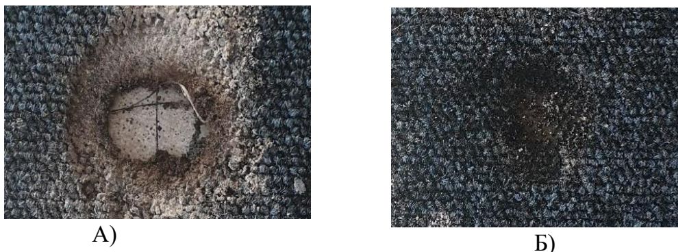
Рис. 4. Образец 4 ковровая напольная плитка марки «ESSENCE» в месте контакта с раскаленным углем на 60 минуте исследования А) образец угля «Carbopol», Б) образец угля «Cocos»
