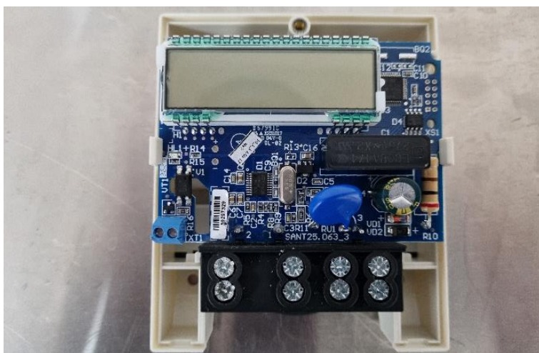
Рис. 2. Монтажная печатная плата однофазного, однотарифного счетчика активной электрической энергии СЕ 101 «Энергомера» с типом корпуса R5.1
