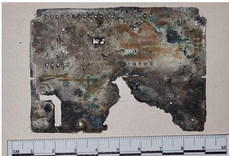
Рис. 1. Остатки монтажной печатной платы, обнаруженной в пожарном мусоре
