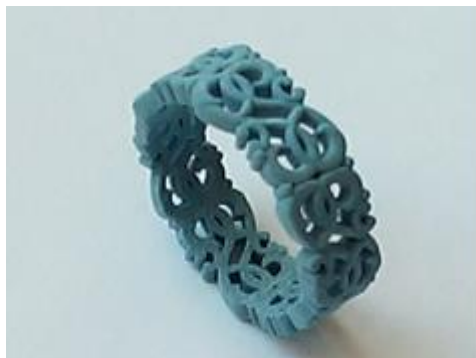
Рис. 4. Восковая модель, выполненная по эскизам при помощи MSM технологии
