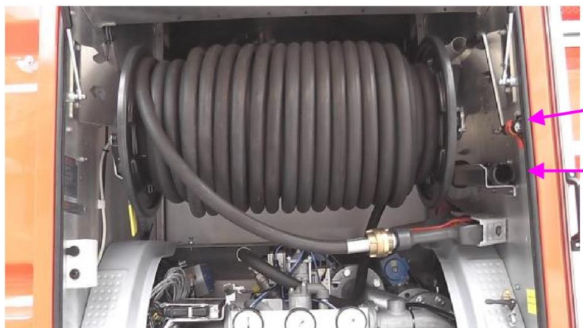
Рис. 1. Расположение катушки высокого давления с СРВД на автомобиле
