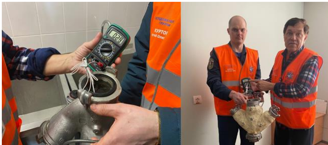
Рис. 3. Фрагменты экспериментальных исследований по определению эффективности теплозащиты РТ-80, выполненной путем нанесения слоя пенополиуретановой монтажной пены (фото авторов)
