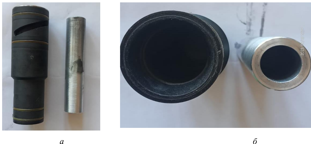
Рис. 2. Втулка для изменения (уменьшения) потока огнетушащих средств: главный вид – а , вид сбоку – б
