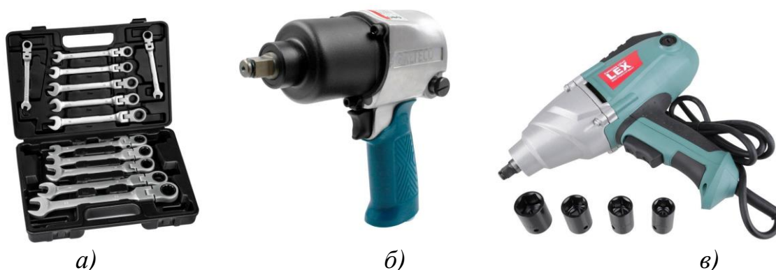
Рис. 1. Инструмент для работы с резьбовыми соединениями: а – ручные гаечные ключи; б – пневматический гайковерт; в – электрический гайковерт.
