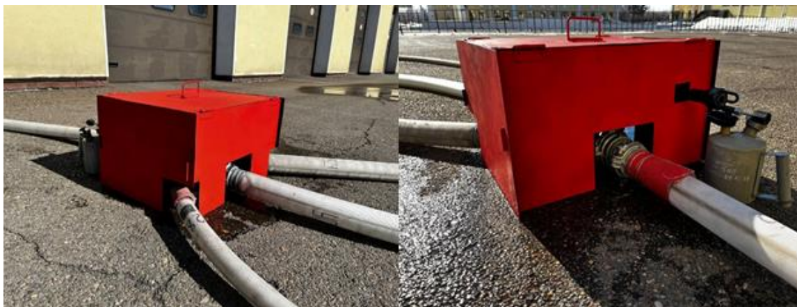
Рис. 2. Вид разработанного авторами компактного раскладного устройства, позволяющего повысить эффективность работы насосно-рукавных систем в условиях воздействия отрицательных температур окружающей среды [4]
