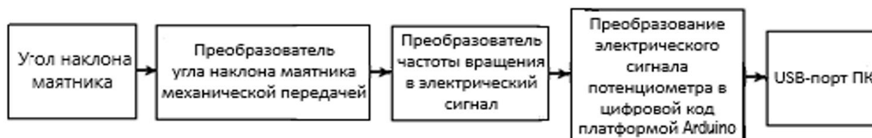
Рис. 2. Структурная схема системы измерения параметров испытания на растяжение на основе преобразования угла отклонения маятника разрывной машины в цифровой код платформы Arduino
