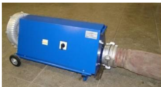
Рис. 2. Установка СР-3 с пожарным рукавом диаметром 150 мм
