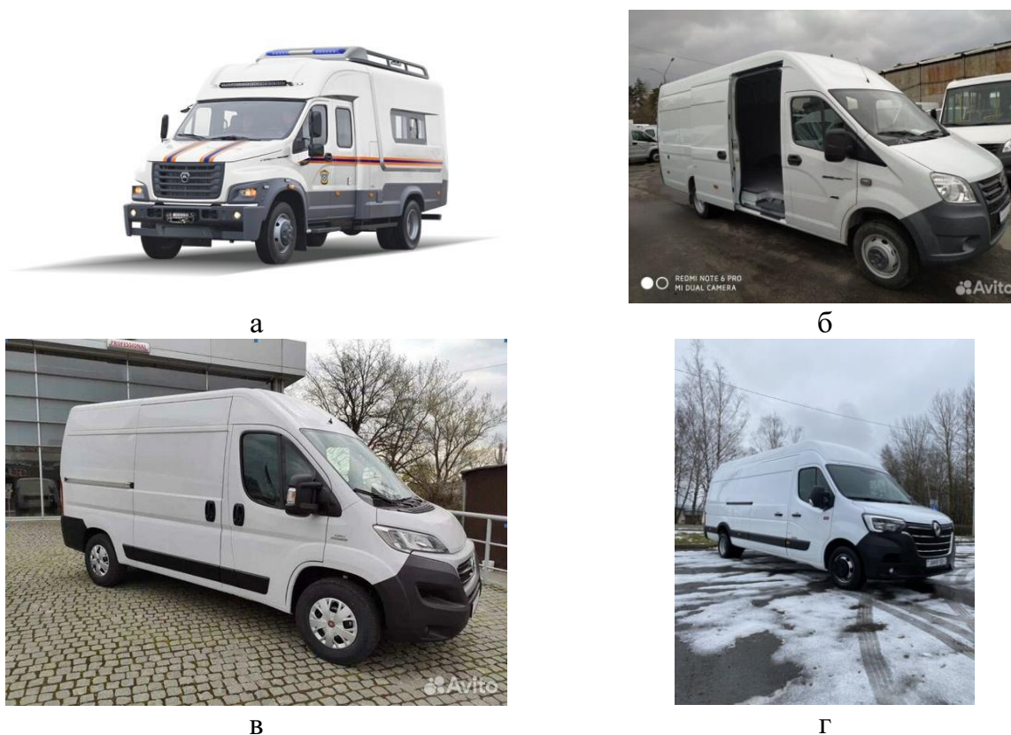
Рисунок. Конкурентоспособные автомобили, подходящие в качестве базового шасси для подвижной метрологической лаборатории: а – ГАЗон-NEXT в монокузове; б – Газель «Некст» С45R02; в – FIAT DUCATO L2/L3H2; г – Renault Master L3H2
