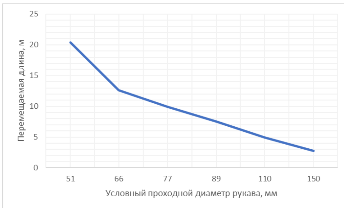
Рис. 2. Зависимость длины заполненного рукава при перетаскивании его по асфальту от величины условного проходного диаметра
