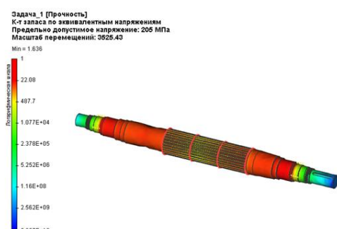
Рис. 3. Коэффициент запаса по эквивалентным напряжениям, сталь 30
