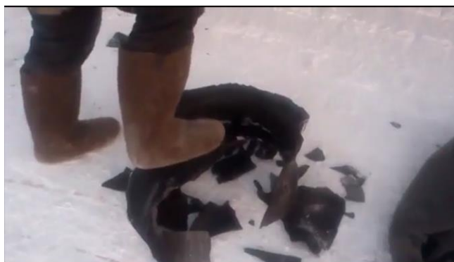
Рис. 2. Пример потери эластичности резины при отрицательных температурах
