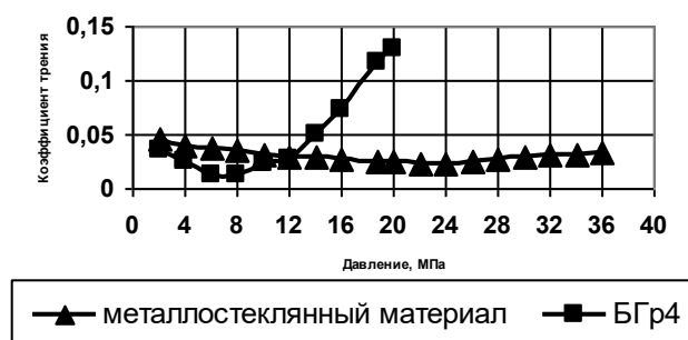
Рис. 1. Зависимость коэффициента трения от давления для БГр4 и разработанного металлостеклянного материала
