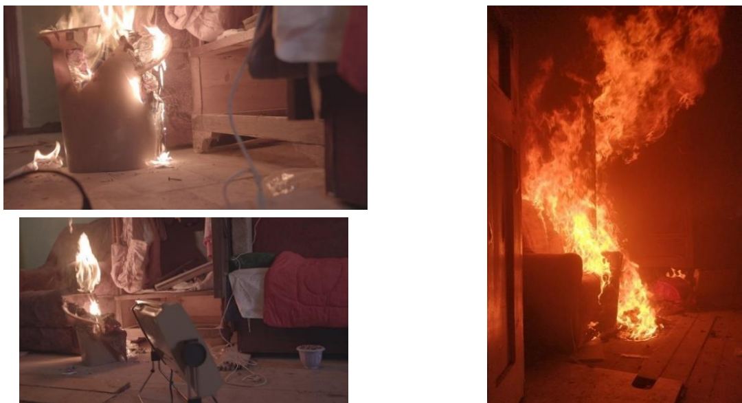
Рис. 1. Открытые горение мусорного ведра, платяного шкафа и кресла
