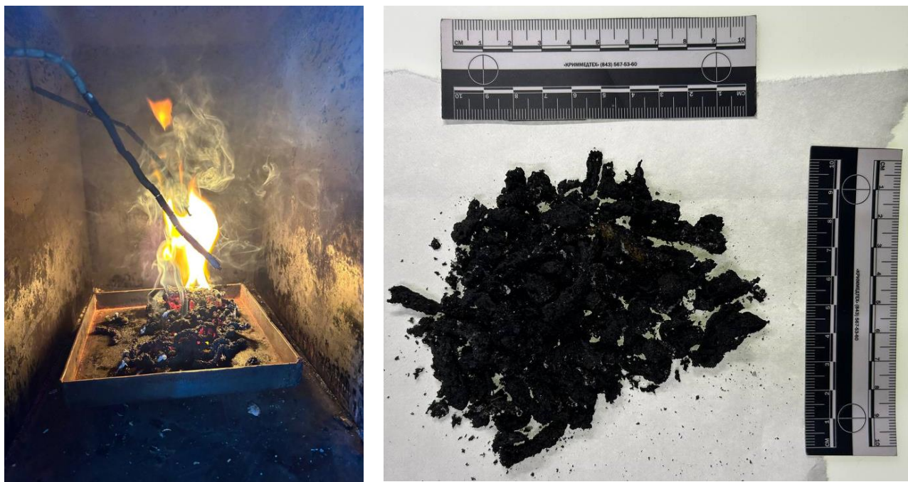
Рис. 6. Процесс горения и зольный остаток образца № 3
