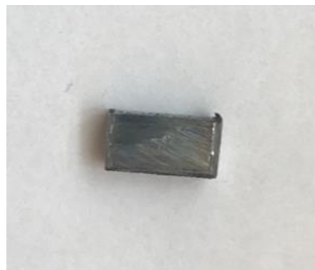
Рис. 6. Образец стали марки Ст3сп после пребывания в водном растворе Рофамин Т (0,1 мг/мл)
