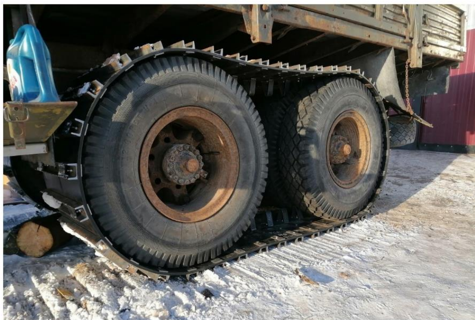
Рисунок. Резинометаллические гусеницы, установленные на колеса автомобиля
