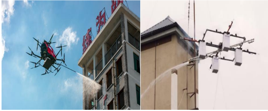
Рис. 4. Виды зарубежных пожарных БПЛА (слева – китайский дрон фирмы EHang; справа – латвийский дрон от компании Aeronex)
