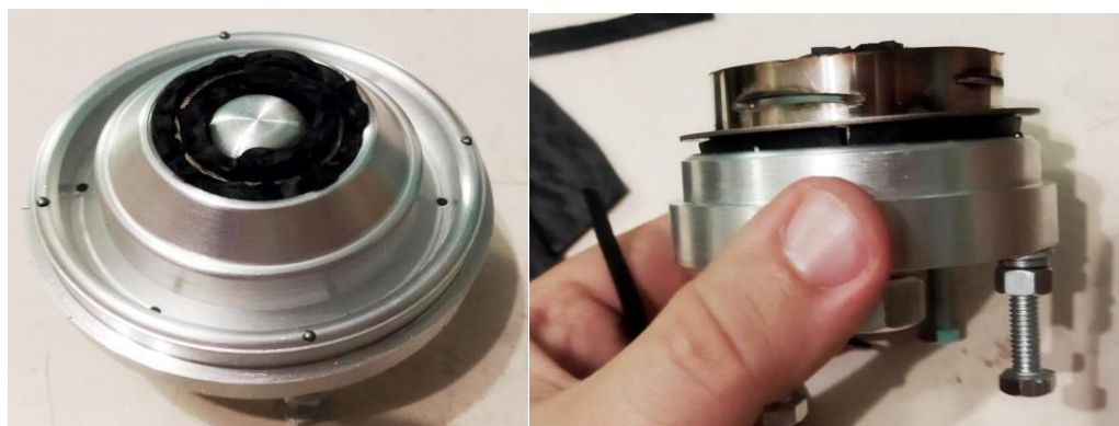
Рис. 3а,б. Заполненная сырой резиной каркас и полость между пуансоном и пальцем
