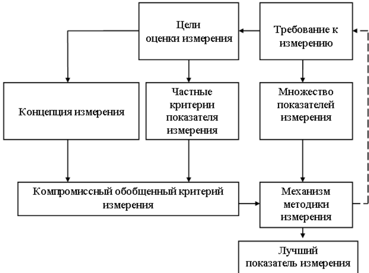
Рис.3. Структурно-логическая схема измерения ПДК вредных веществ безопасности предприятия по производству смазок и смазочного материала
