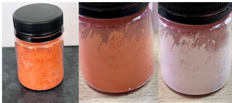
Рис. 1. Переход окраски пигмента от оранжевого до бледно-розового при изменении температуры от 30°С до 68°С
