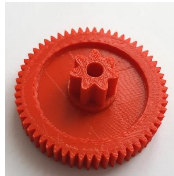
Рис. 3 Трехмерная модель шестерни (а) и изготовленная по ней деталь (б)
