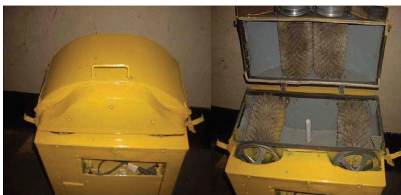
Рис. 3 Переносная экспресс мойка пожарных рукавов
