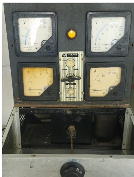
Рис. 1. Внешний вид установки для моделирования токовых перегрузок
