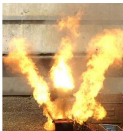
Рис. 2. Замыкания и последующее горение литий-ионного аккумулятора [1]
