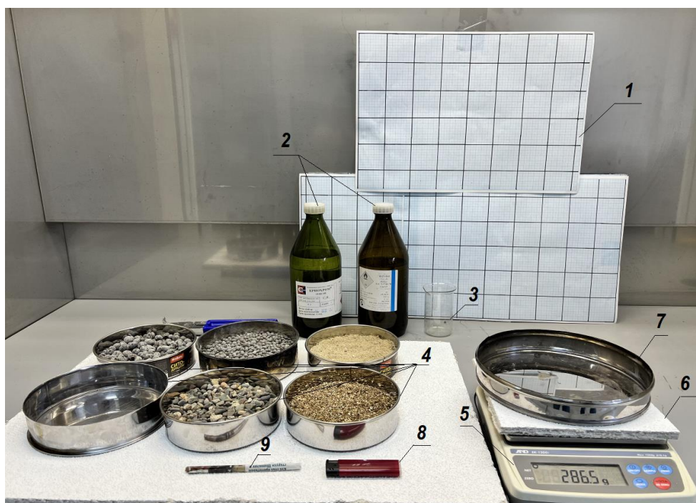
Рис. 2. Лабораторное оборудование для проведения эксперимента: 1 – миллиметровка с разметкой 50×50 мм; 2 – емкости с ЛВЖ; 3 – мерный стакан; 4 – емкости-сито с гранулированным наполнителем и без него; 5 – аналитические весы AND EK-1200i; 6 – теплоизоляционный материал; 7 – емкость из нержавеющей стали; 8 – зажигалка; 9 – фитиль для поджигания ЛВЖ
