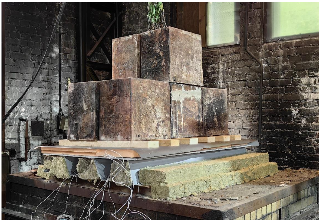
Рис. 2. Опытный образец фрагмента конструкции настила покрытия системы “МАКСИ ALL” с нанесенным огнезащитным покрытием ООО “РЕПРОЗА” с обогреваемой стороны, подготовленный к огневому испытанию
