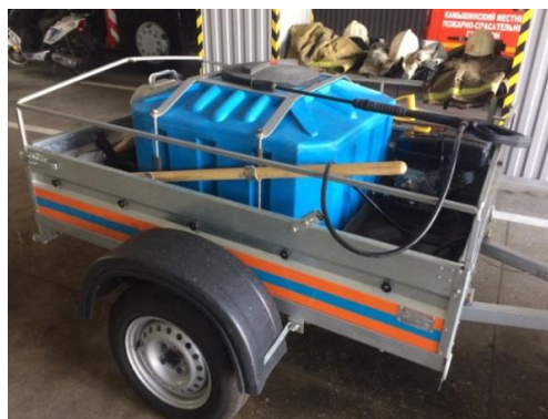
Рис. 1. Прицепной пожарный модуль для квадроцикла
