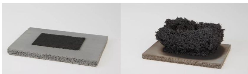
Рис. 2. Принцип действия интумесцентного (вспучивающегося) огнезащитного покрытия
