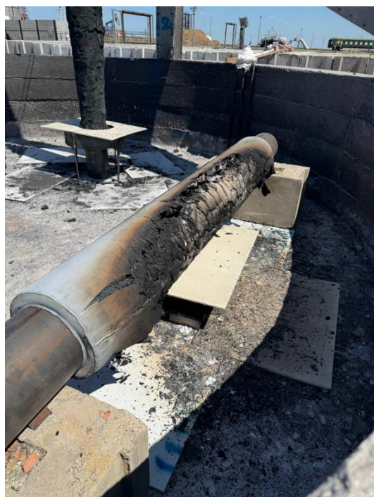
Рисунок. Результаты огневых испытаний на воздействие пожара пролива и факельное горение соответственно
