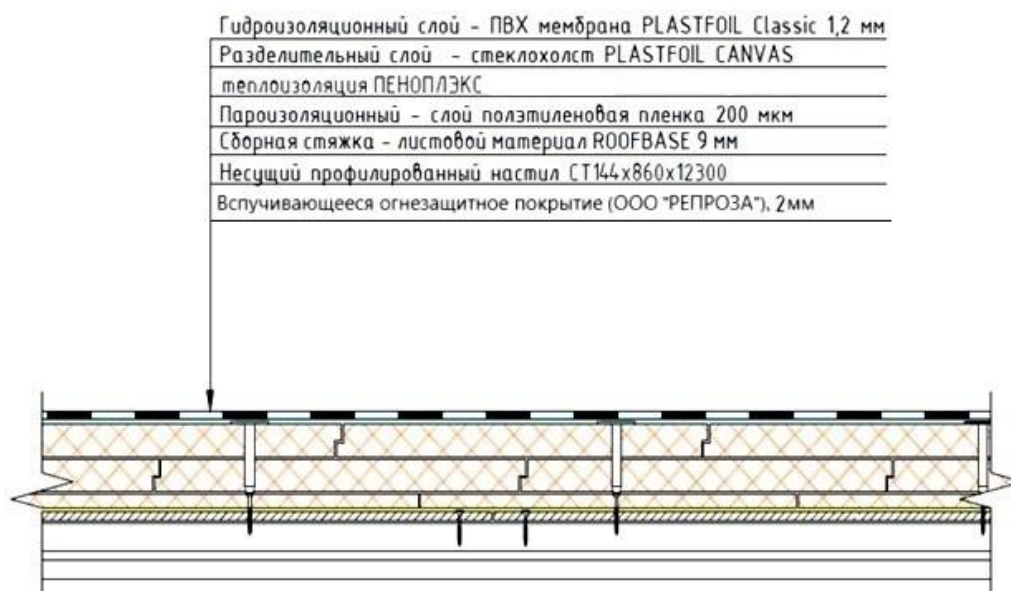
Рис. 1. Конструктивная схема опытного образца фрагмента конструкции настила покрытия системы “МАКСИ ALL” с вспучивающимся огнезащитным покрытием
