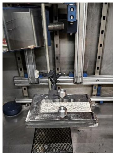
Рис. 2. Рамка с исследуемым образцом, установленная горизонтально в камеру
