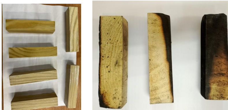
Рисунок. Фото образцов до и после испытания в «Керамический короб»
