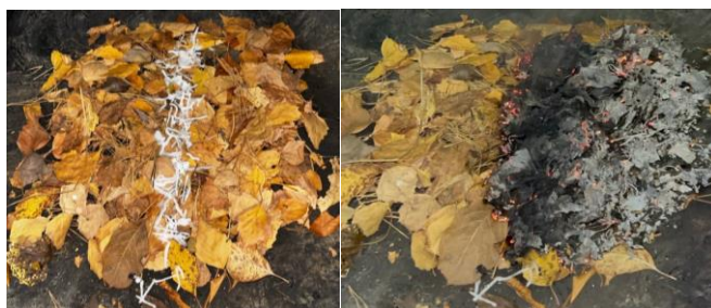
Рис. 7. Фото тушения тонкослойным аэрозолеобразующим огнетушащим пироэлементом сухой листвы в камере пожаротушения
