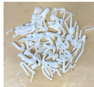
Рис. 6. Фото тонкослойных аэрозолеобразующих огнетушащих пироэлементов
