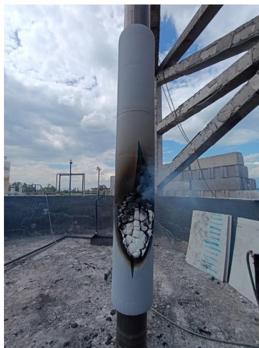
Рисунок. Результаты огневых испытаний на воздействие пожара пролива и факельное горение соответственно
