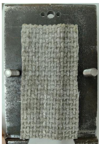
Рис. 1. Исследуемый образец на рамке для определения скорости распространения пламени
