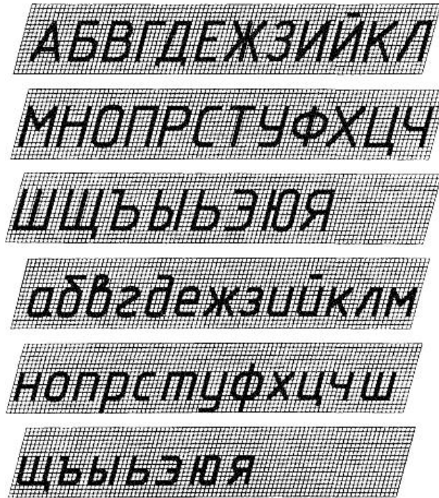
Рисунок 4.4 – Шрифт типа Б с наклоном
