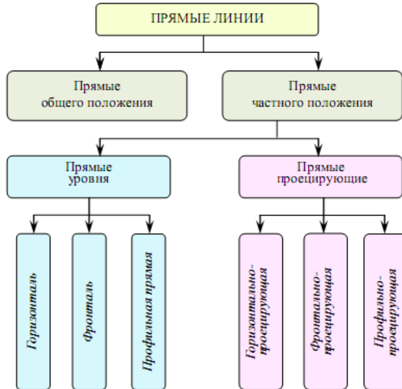
Рисунок 1.4 – Классификация прямых по положению относительно плоскостей проекций
