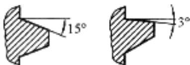
Рис.2.10 Виды сечений витка резьбы.
