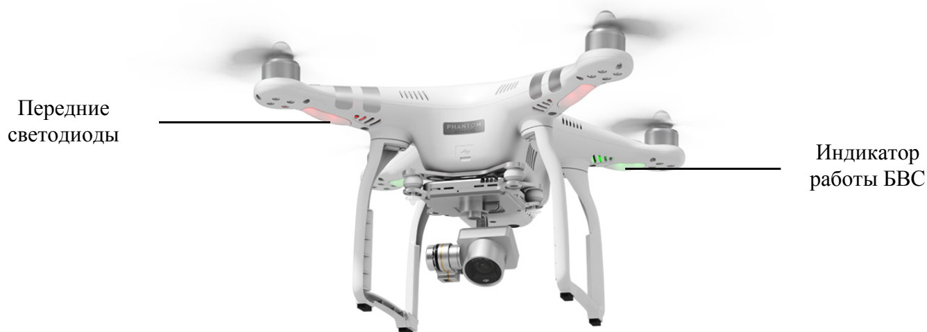
Рис. 8.1. Светодиоды и индикаторы работы БВС
