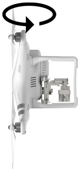
Рис. 9.2. Вращение БВС в вертикальном положении
