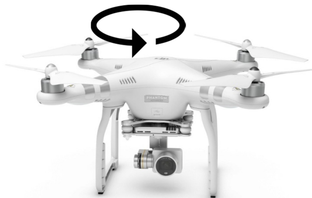
Рис. 9.1. Вращение БВС в горизонтальном положении
