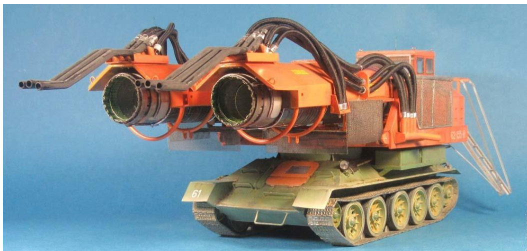
Рис. 2. Танк Т-34 с установкой газонефтяного тушения
