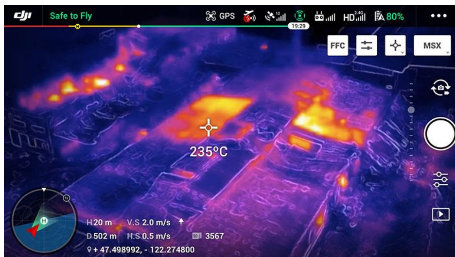
Рис. 3. Разведка пожара при помощи тепловизора DJI Mavic 2 Enterprise Advanced
