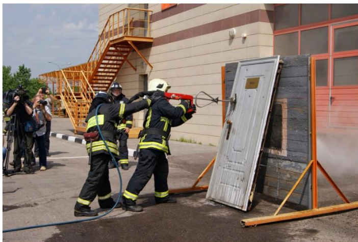
Рис. 3. Тушение условного пожара с помощью установки гидроабразивной резки «Кобра»
