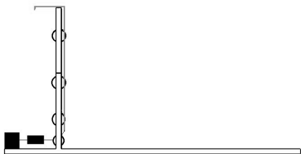
Рис. 4. Схема испытания лестницы штурмовки
