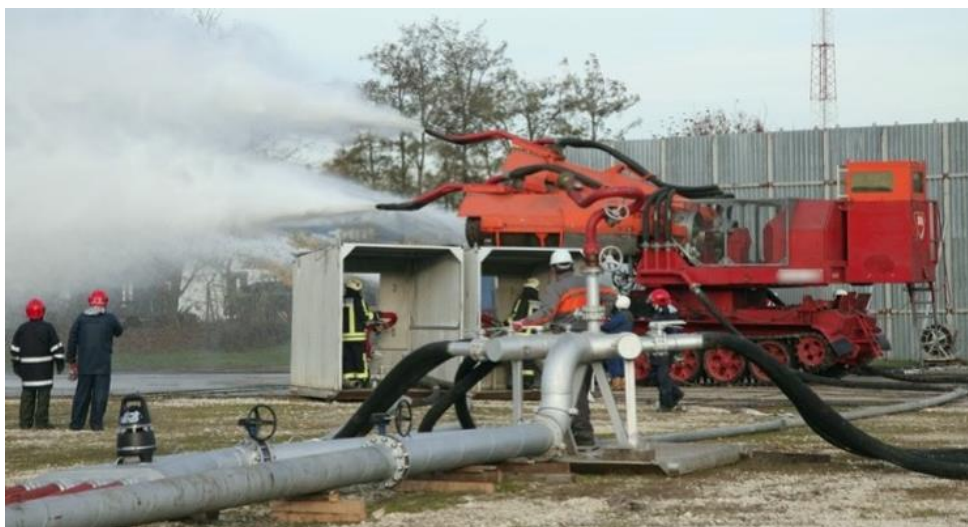
Рис. 4. Принцип тушения газовойдуяного тушения танка Т-55
