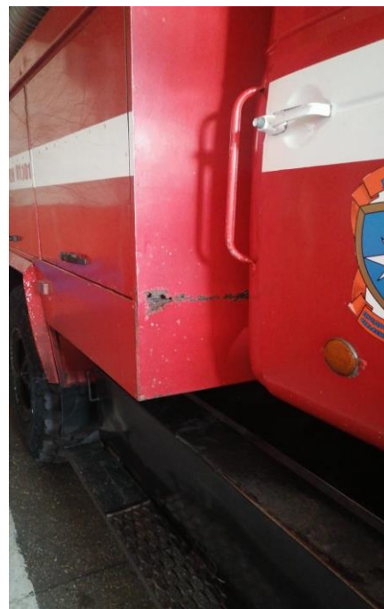
Рис. 2. Коррозия на надстройке АЦ-3,0-40(43206)
