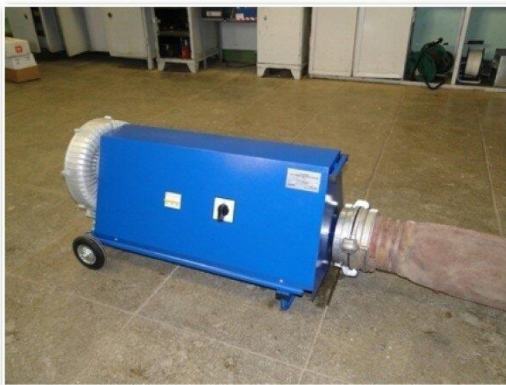
Рис. 5. Пример подсоединения пожарного рукава диаметром 150 мм к установке для сушки пожарных рукавов СР-3
