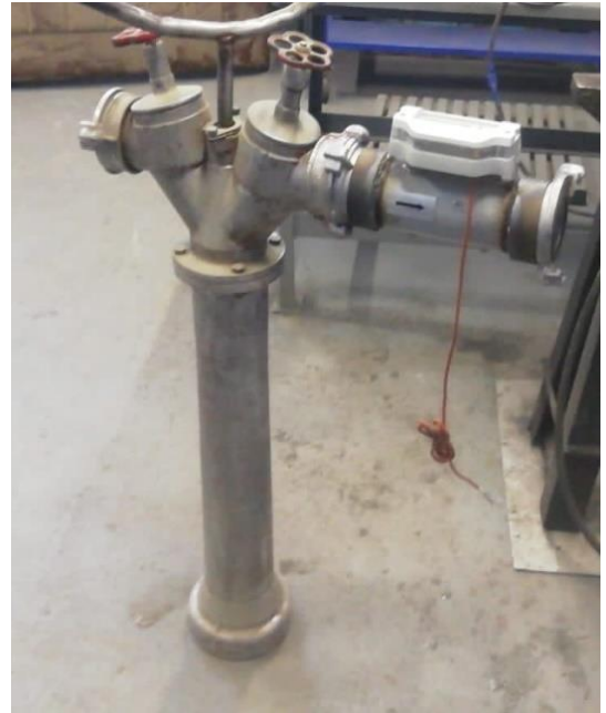
Рис. 1. Ультразвуковой расходомер на пожарной колонке
