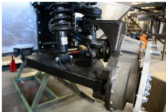
Рис. 3. Бортовые редукторы вездехода «Бурлак»
