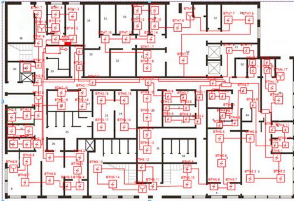
Рис 1. Планировка 1 этажа объекта с указанием схемы автоматической пожарной сигнализации
