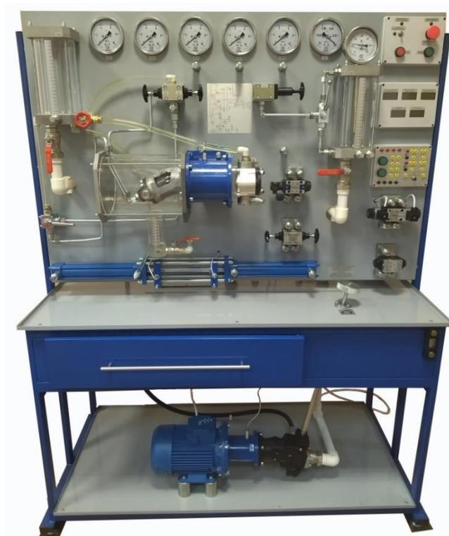
Рисунок 2 – Типовой комплект учебного оборудования «Регулируемые гидромашины, гидроприводы и гидроавтоматика».
