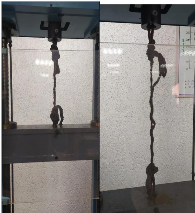
Рисунок 5 – Эксперимент с пеньковой веревкой (мокрая).
