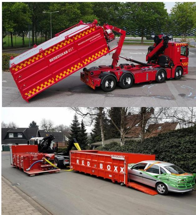
Рисунок 2 – Пожарный автомобиль с контейнером для погружения электромобиля
