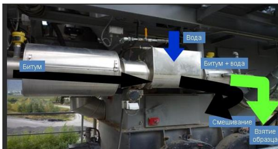
Рис. 3. Механическое вспенивание битума пеногенератором AMMANN
