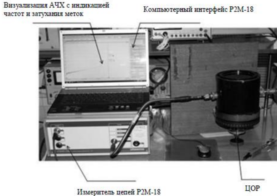
Рис. 1. Внешний вид экспериментальной установки с использованием скалярного измерителя параметров цепей P2M-18 и ЦОР
