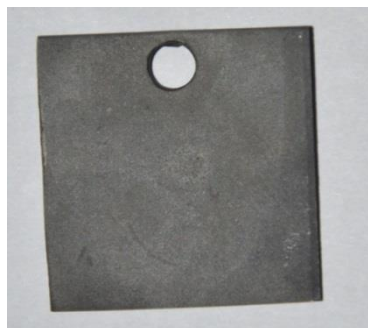
Рис. 1. Фосфатное покрытие, полученное холодным способом
