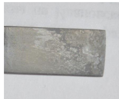
Рис. 3. Белое фосфатное покрытие из раствора с добавкой нитрата кальция
