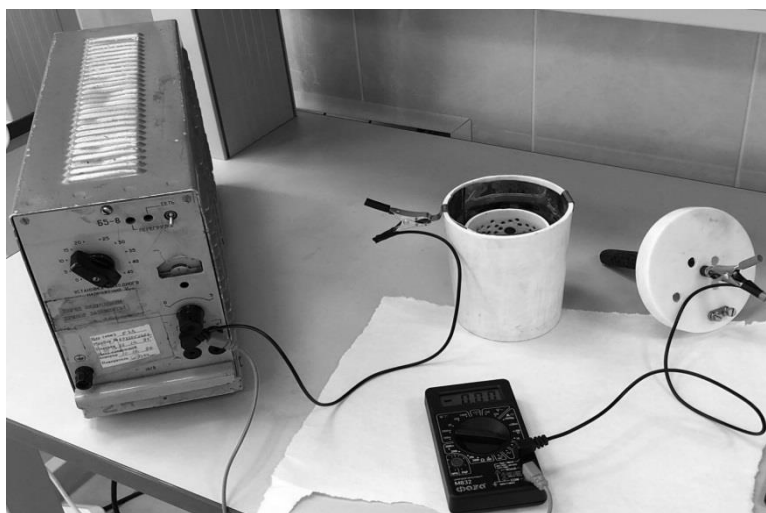
Рис. 2. Общий вид лабораторной установки: электролизер, крышка электролизера с графитовым анодом, источник постоянного тока, мультиметр
