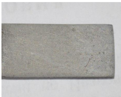
Рис. 2. Белое фосфатное покрытие из раствора с добавкой нитрата цинка
