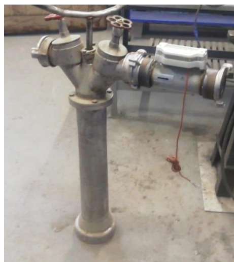
Рис. 1. Ультразвуковой расходомер на пожарной колонке
