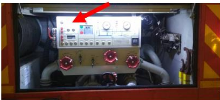
Рис. 2. Условная схема расположения радиостанции в НЦПН 40/100М-ПЗ, установленном на УРАЛе 5557
