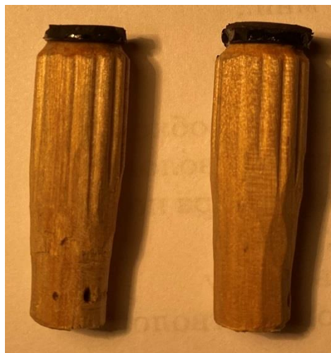
Рис. 1. Опытные образцы с резиновым и магнитным эластомерным покрытием
