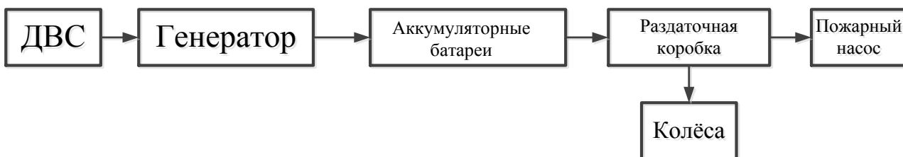
Рис. 4. Принципиальная схема работы трансмиссии гибридного пожарного автомобиля
