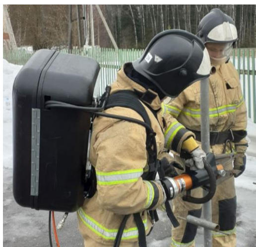
Рис. 1. Пневмогидравлический привод, совмещенный с дыхательным аппаратом
