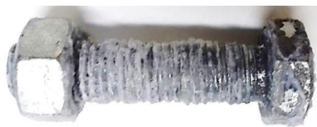
Рис. 3. Болт М12 с гайкой и продуктами коррозии цинка (выдержка 14 суток)
