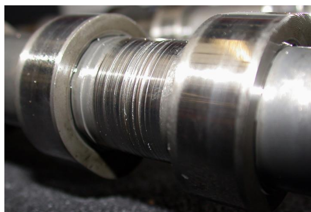
Рис. 1. Следы износа на шейках валов
