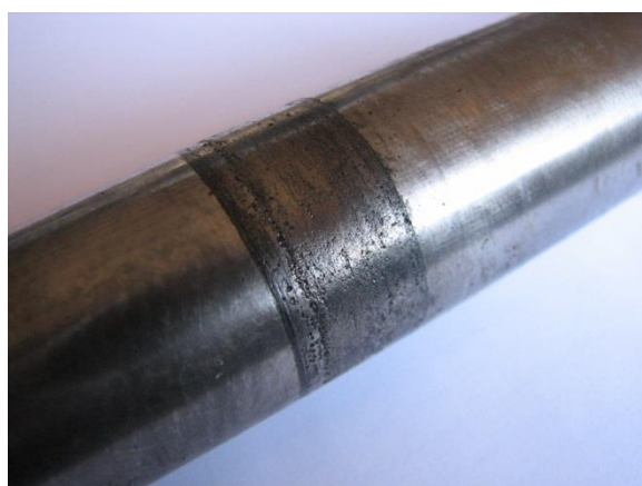
Рис. 1. Следы износа на шейках валов
