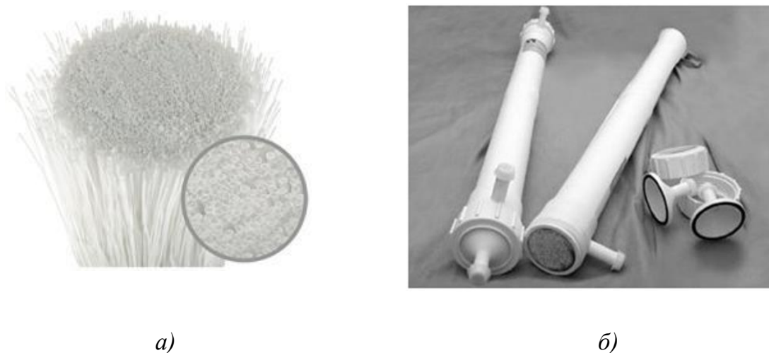
Рис. 1. Ультрафильтрационный аппарат: а) капиллярные трубчатые мембраны; б) ультрафильтрационный аппарат в сборе
