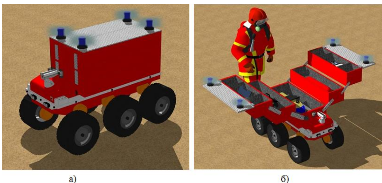
Рис. 2. Робототехническое устройство для перевозки аварийно-спасательного инструмента: а – вид устройства в закрытом виде, б – вид устройства в открытом виде
