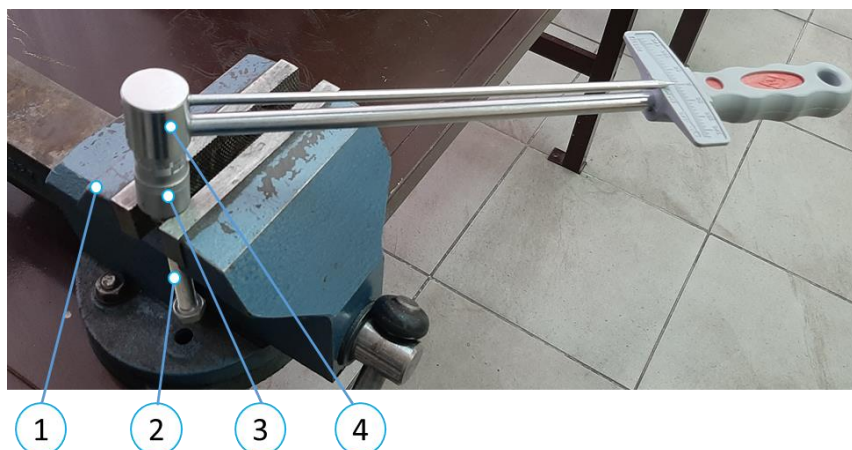
Рис. 2. Испытательный стенд для затяжки/откручивания резьбовых соединений с нормированным усилием: 1- тиски слесарные; 2 - резьбовое соединение «Болт М12-две гайки»; 3 – головка торцевая; 4 - ключ моментный показывающий КМ-140
