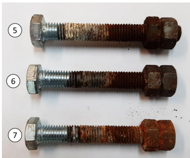
Рис. 1. Резьбовое соединение «Болт М12х50мм – две гайки» после выдержки в соляном растворе на протяжении 60 сут.: 5- резьбовое соединение с Нигролом; 6 - резьбовое соединение с пластичной смазкой Литол-24; 7 - резьбовое соединение с герметиком Red RTV Silicone Gasket Maker
