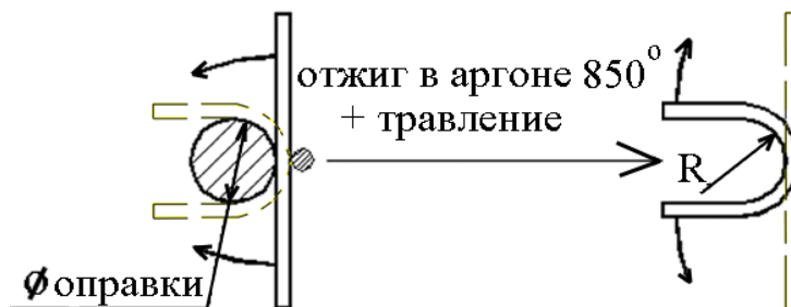
Рис. 4. Схема изготовления образцов с деформацией изгиба
