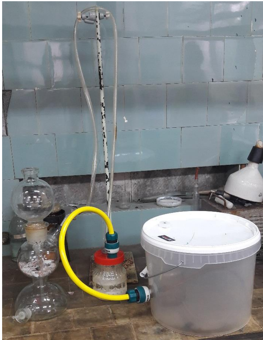
Рисунок 2.2 – Лабораторная установка для моделирования условий в газовой фазе ПВХ
