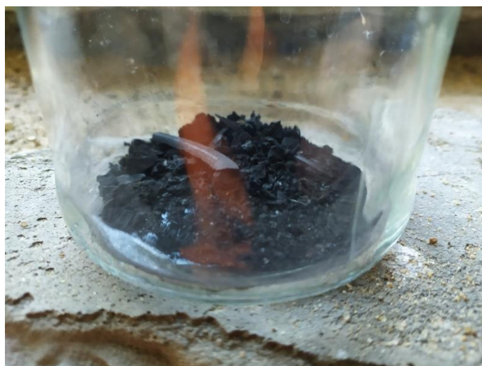
Рисунок 3.29 – Фотографии удаленных с поверхности образцов продуктов коррозии
