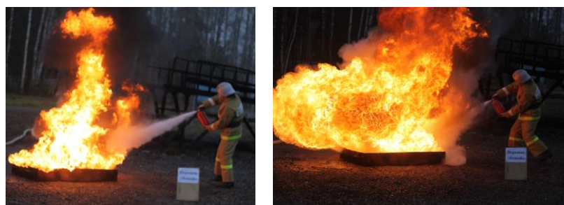
Рисунок 12 – Образование «огненной сферы» при подаче огнетушащего порошка в зону горения (промышленные испытания)
