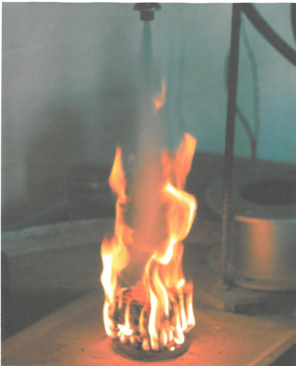
Фотография 4 – Тушение модельного очага Класса А огнетушащим порошковым составом
