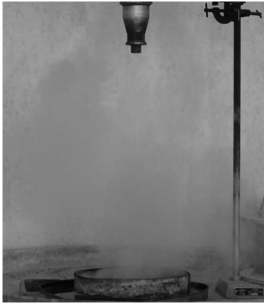
Рисунок 2.11 – Потухание модельного очага с ЛВЖ в результате воздействия ОПС
