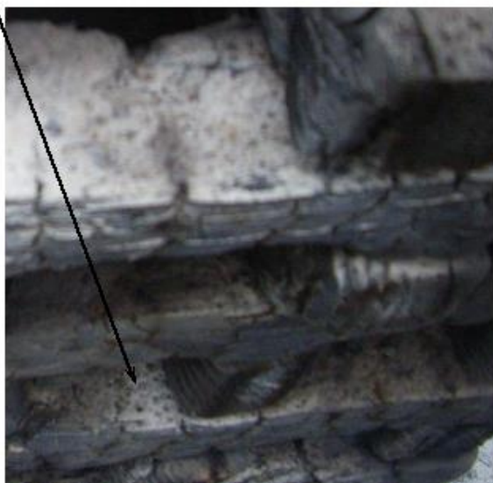
Рисунок 3.30 – Фото следов разрушенных капсул на поверхности брусков древесины
