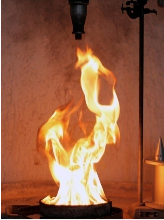
Рисунок 2.7 – Свободное горение модельного очага с ЛВЖ
