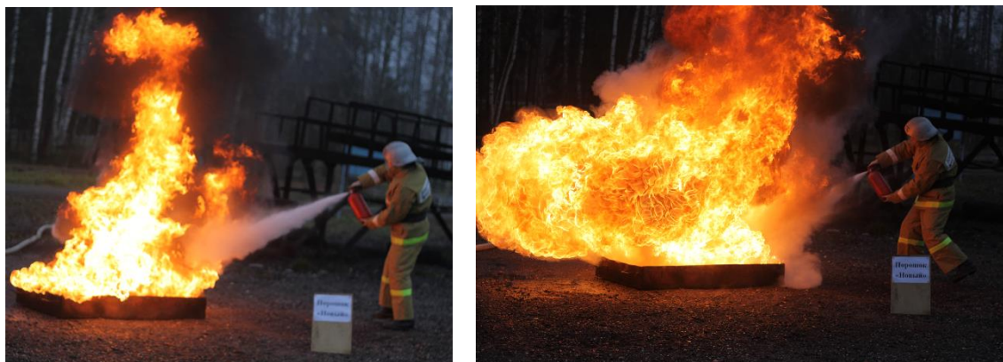
Рисунок 4.2 – Образование «огненной сферы» при подаче огнетушащего порошка в зону горения (промышленные испытания)
