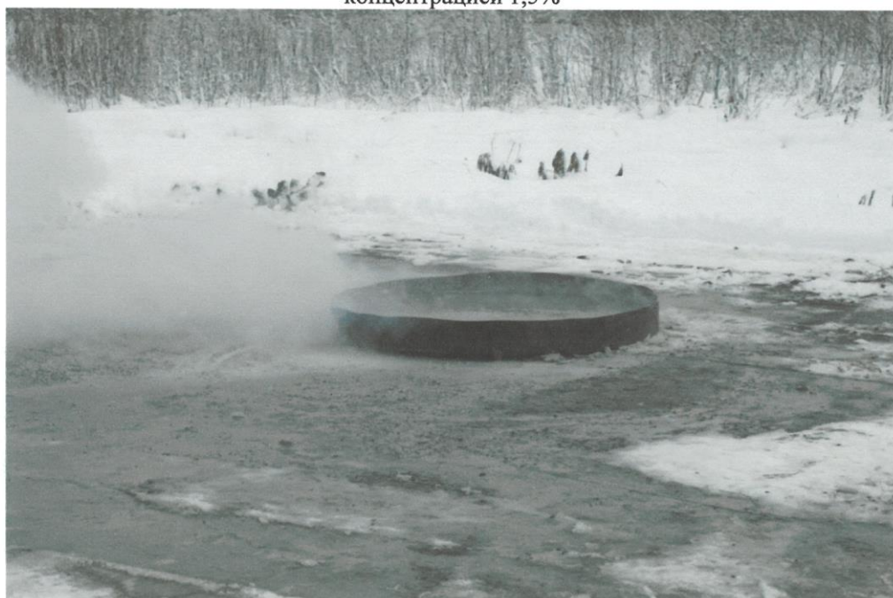
Фотография 6. Потухание модельного очага пожара (Класс 55В) в результате воздействия огнетушащего порошка
