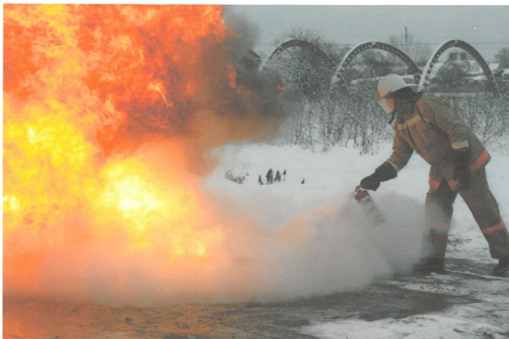
Фотография 5. Тушение модельного очага пожара (Класс 55В) огнетушащим порошковым составом на основе «ВОЛГАЛИТ-АВС» с применением гидрофобизирующей добавки «ГМД» с концентрацией 1,5%
