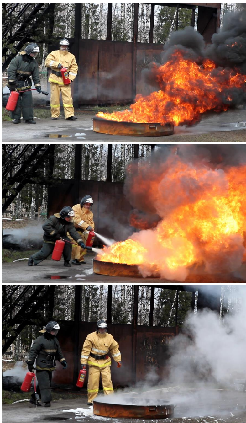
Рисунок 3.41 – Одновременное тушение модельного очага пожара класса 55В порошковым и пенным огнетушителями
