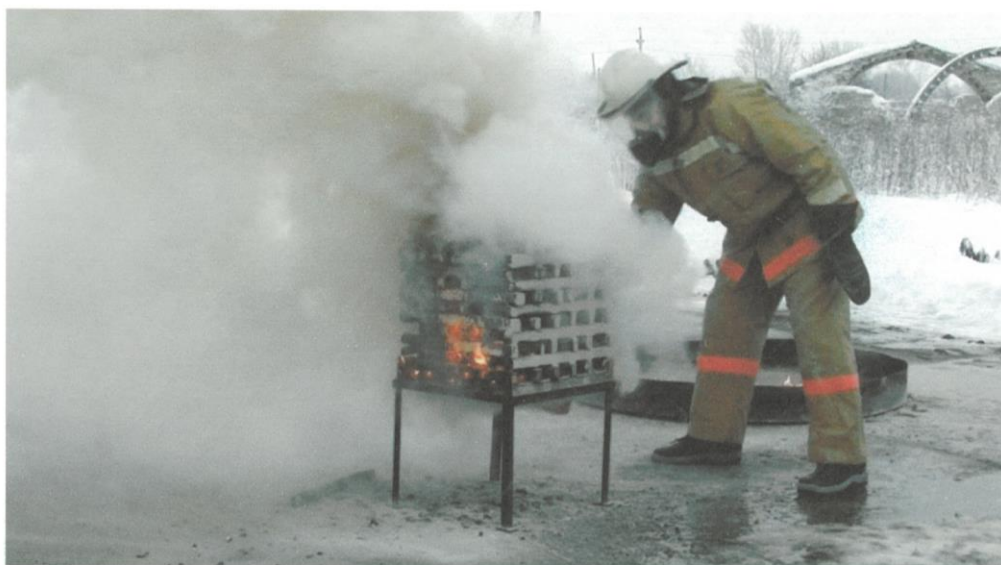
Фотография 2. Тушение модельного очага пожара (Класс 1А) огнетушащим порошковым составом на основе «ВОЛГАЛИТ-АВС» с применением гидрофобизирующей добавки «ГМД» с концентрацией 1,5%
