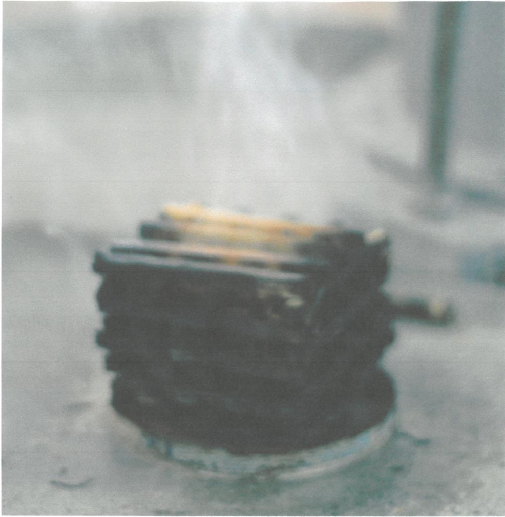
Фотография 6 – Потухание модельного очага Класса А в результате воздействия огнетушащего порошка
