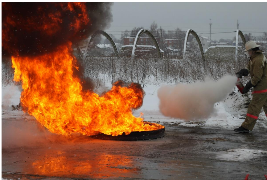
Рисунок 3.38 – Тушение модельного очага пожара класса 55В огнетушащим порошком «Волгалит-АВС» с гидрофобизирующей добавкой ГМД-20НТ (1,5 % по массе)
