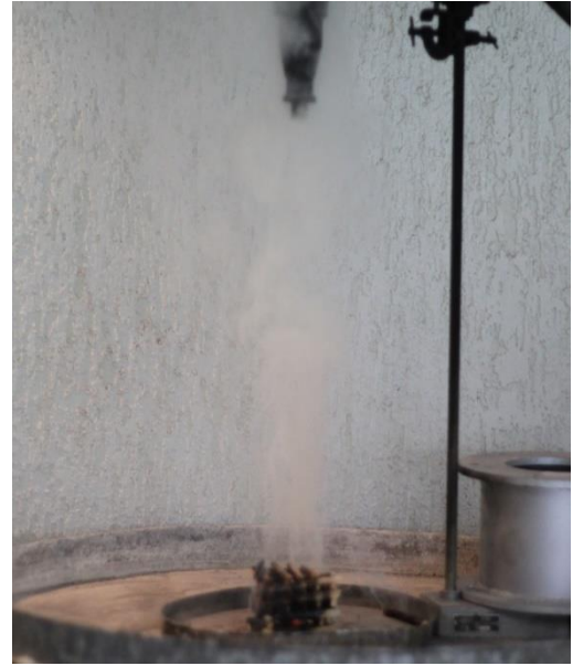
Рисунок 2.12 – Потухание модельного очага с ТГМ в результате воздействия ОПС
