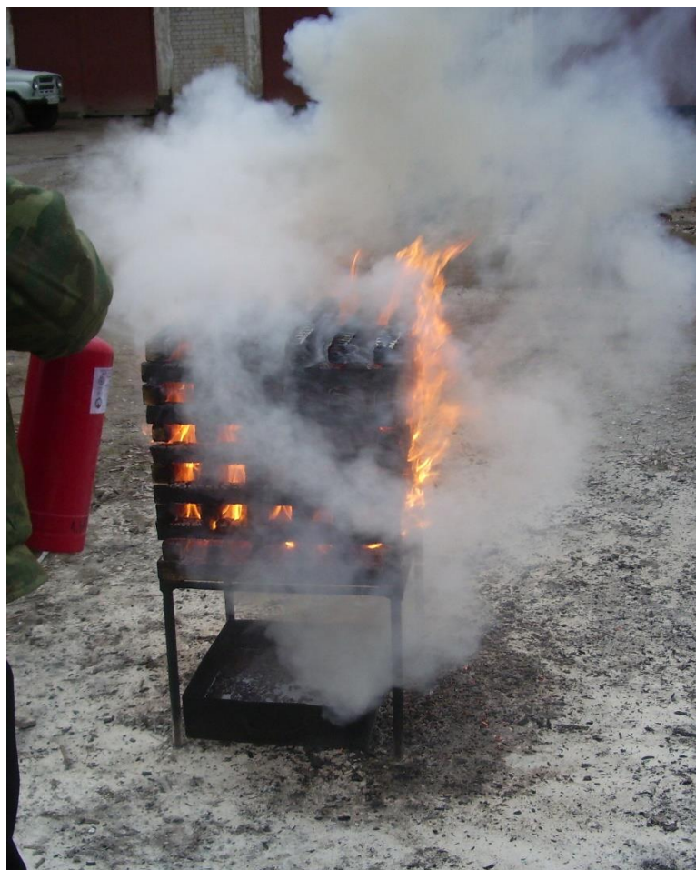
Рисунок 3.28 – Тушение модельного очага пожара класса 1А (горение штабеля древесины) огнетушителем ОП-3
