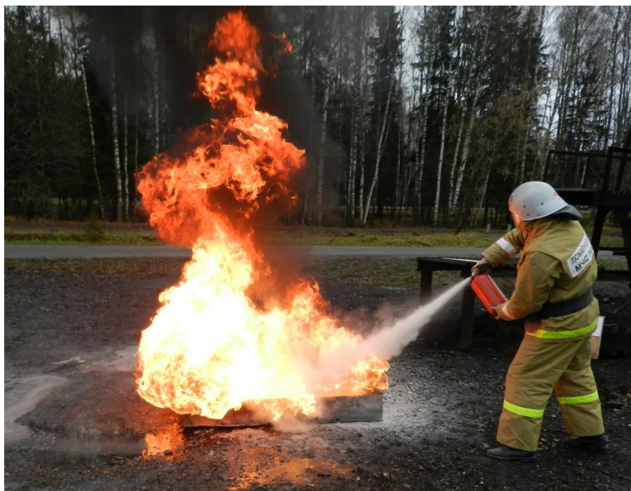
Рисунок 3.34 – Тушение модельного очага пожара (горение легковоспламеняющейся жидкости) огнетушителем ОП-3
