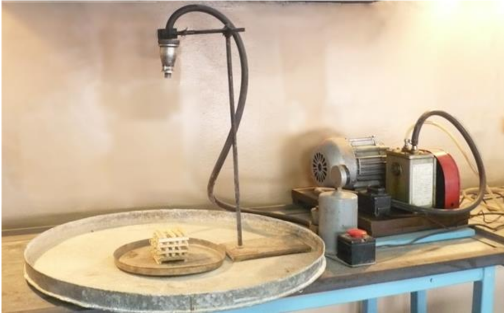
Рисунок 2.2 – Общий вид лабораторной установки для исследования огнетушащей способности порошков
