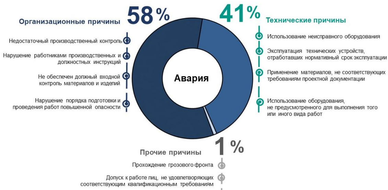
Рисунок 1.8 – Распределение причин аварий на ОПО НГДП за период с 2011 по 2021 г. по их характеру
