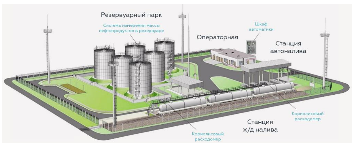
Рисунок 1.2 - Типовая схема планировки склада нефтепродуктов
