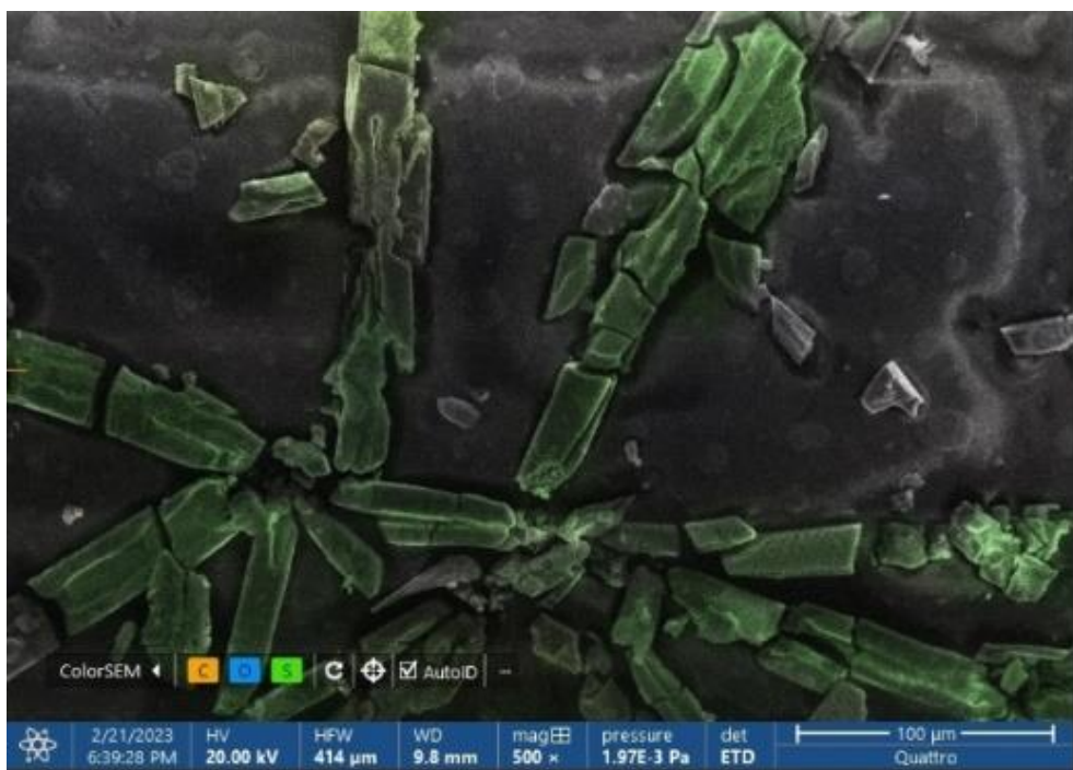
Рисунок 3.22 – Микрофотографии плёнки из полимочевины (К1), полученная методом СЭМ после экспонирования в лабораторной установке и последующей выдержке в вакуумном посту.
