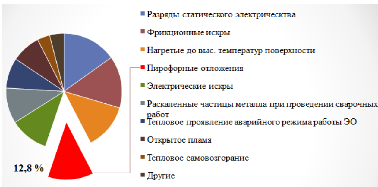
Рисунок 1.8 – Распределение причин пожаров на объектах нефтегазовой отрасли по виду источника зажигания
