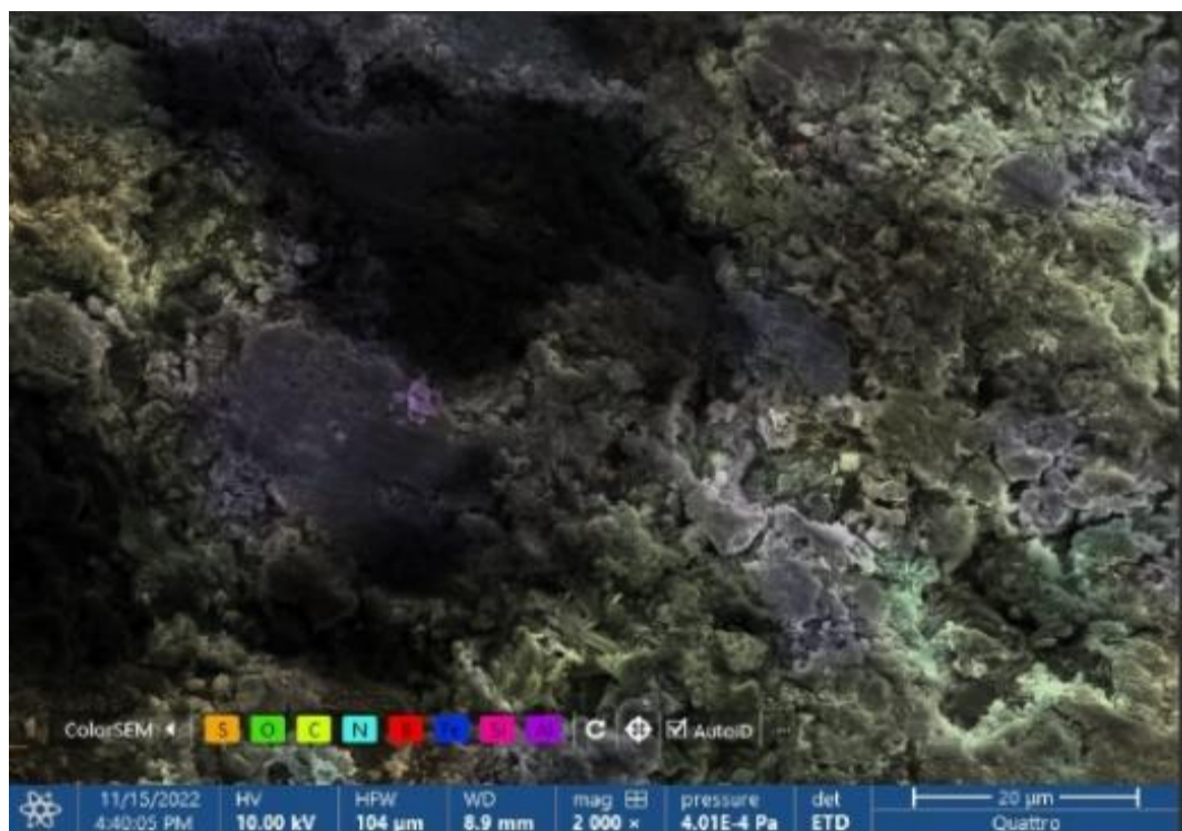
Рисунок 3.15 – Микрофотографии плёнки композитного материала K2, полученная методом СЭМ после экспонирования в лабораторной установке
