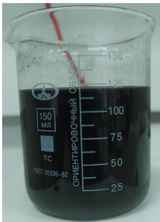
Рисунок 2.4 – Наполнитель композита на основе активированного угля БАУ-А и диоксида титана в реакционной среде этилового спирта после ультразвуковой обработки.
