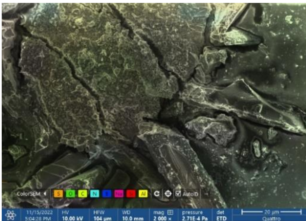
Рисунок 3.20 – Микрофотографии плёнки композитного материала K7, полученная методом СЭМ после экспонирования в лабораторной установке
