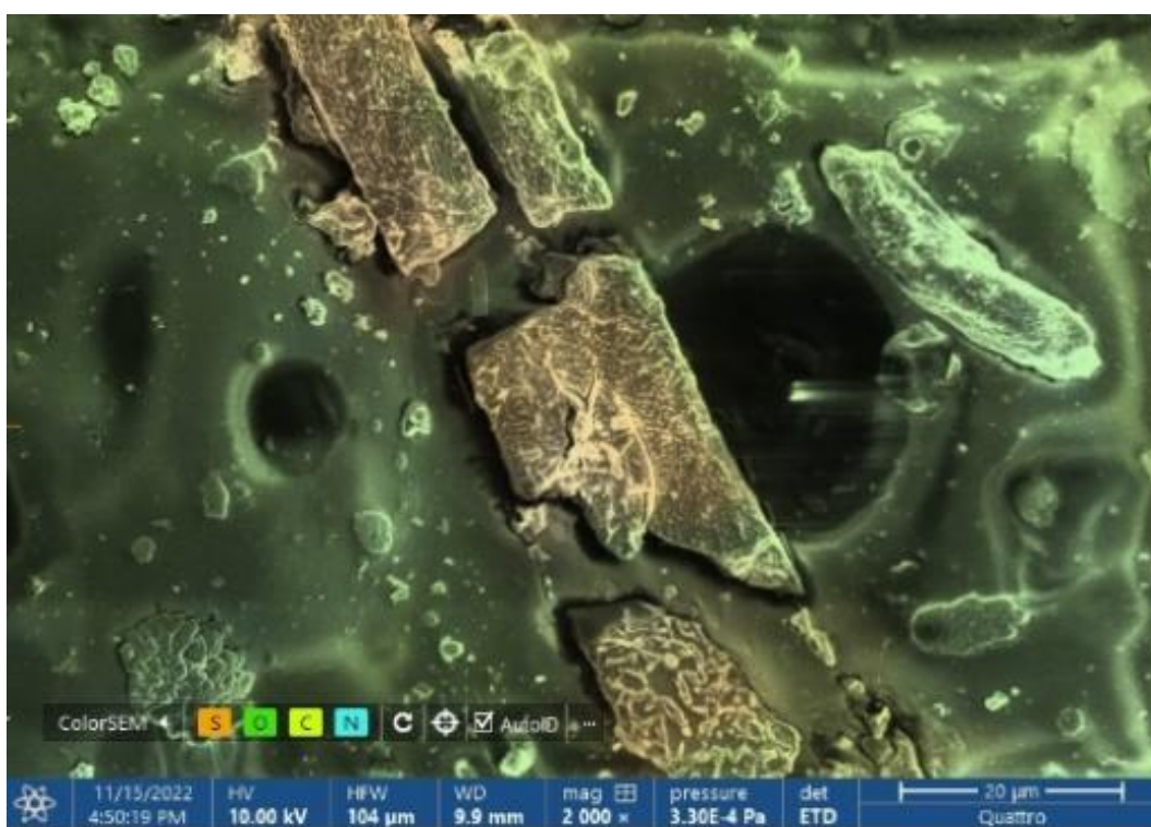
Рисунок 3.17 – Микрофотографии плёнки композитного материала К4, полученная после методом СЭМ экспонирования в лабораторной установке
