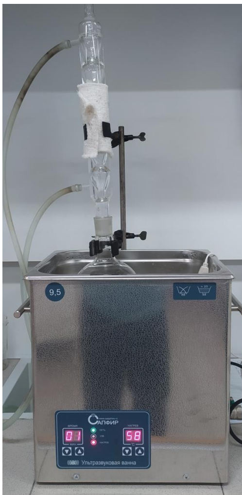
Рисунок 2.3 – Лабораторная установка для синтеза наполнителей композитных материалов, обладающих адсорбционно-окислительными свойствами.
