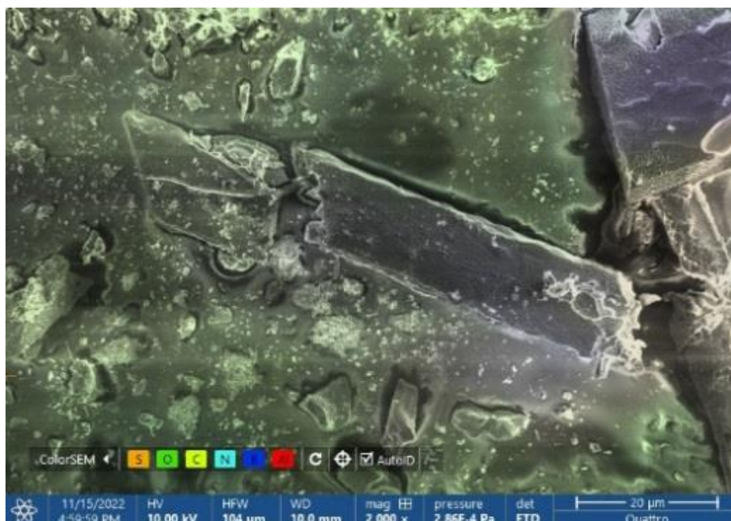
Рисунок 3.19 – Микрофотографии плёнки композитного материала К6, полученная методом СЭМ после экспонирования в лабораторной установке
