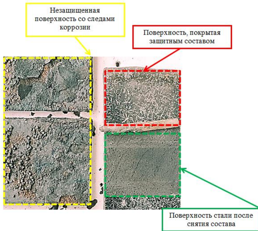
Рисунок 3.12 – Внешний вид образцов, экспонируемых в лабораторной установке в течение 1848 часов
