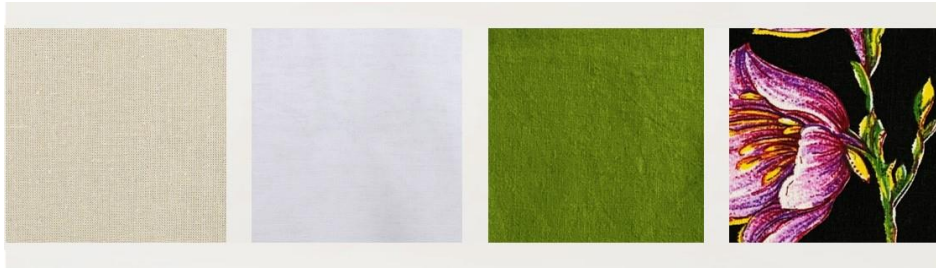
Рисунок 3.10 – Образцы текстильного материала «бязь» различных видов отделки: суровая, отбеленная, гладкокрашенная, напечатанная
