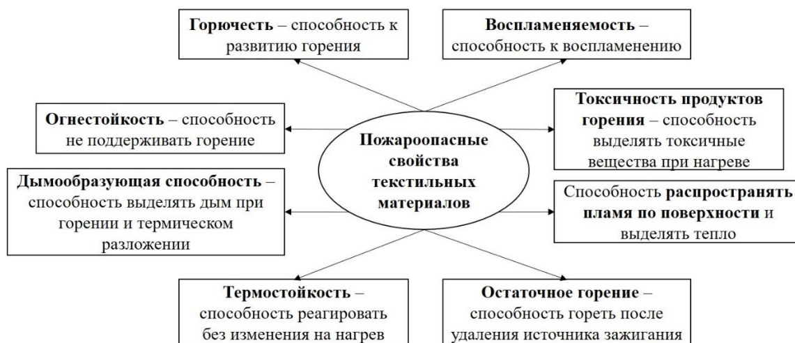
Рисунок 1.3 – Пожароопасные свойства текстильных материалов
