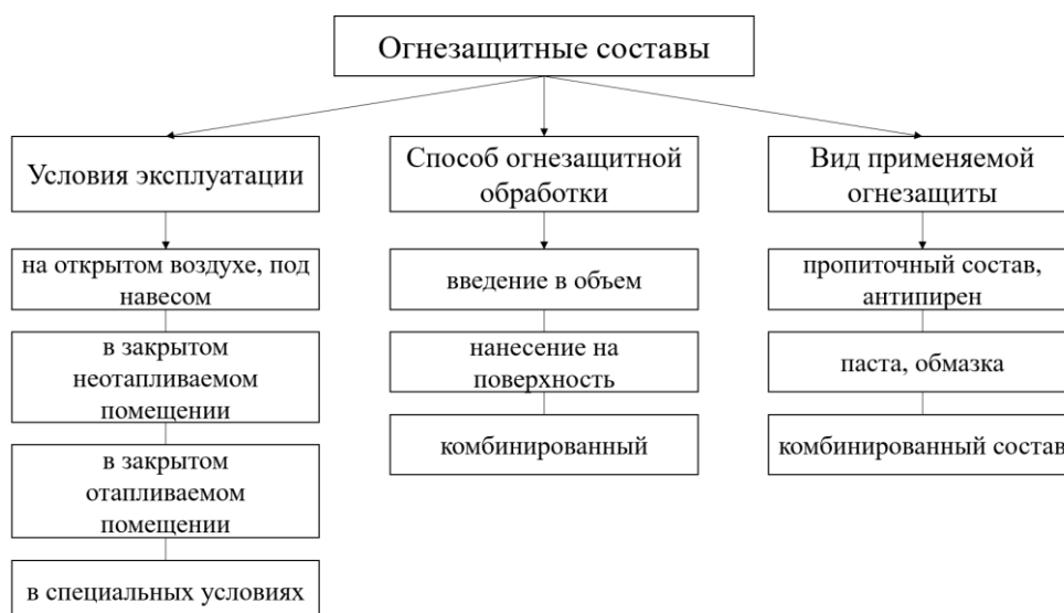
Рисунок 1.6 – Классификация огнезащитных составов
