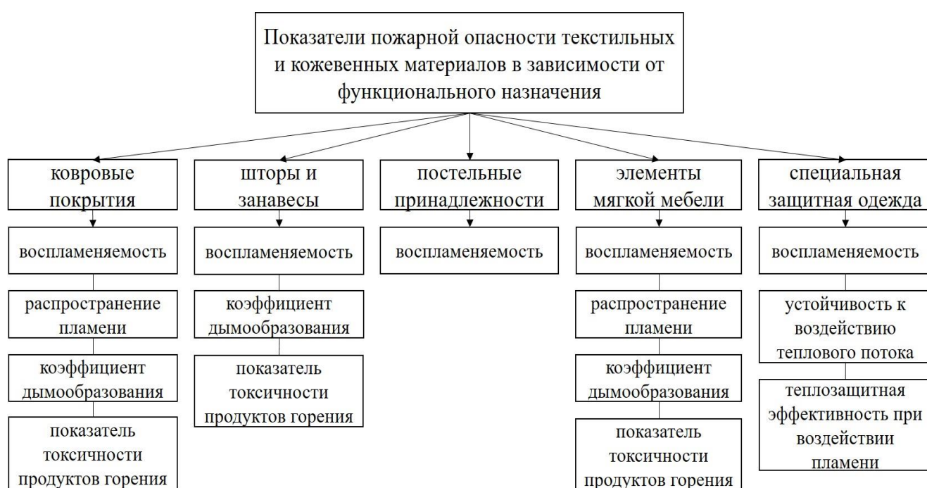
Рисунок 1.5 – Перечень показателей, необходимых для оценки пожароопасных свойств текстильных и кожевенных материалов и для нормирования требований
