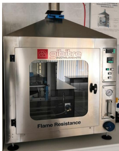
Рисунок 2.2 – Камера для испытания на горение (воспламеняемость) материалов Gibitre Flame Resistance
