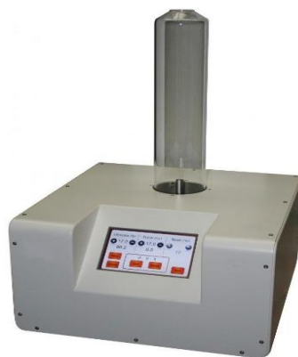
Рисунок 2.7 – Установка для определения кислородного индекса Limiting Oxygen Index Chamber
