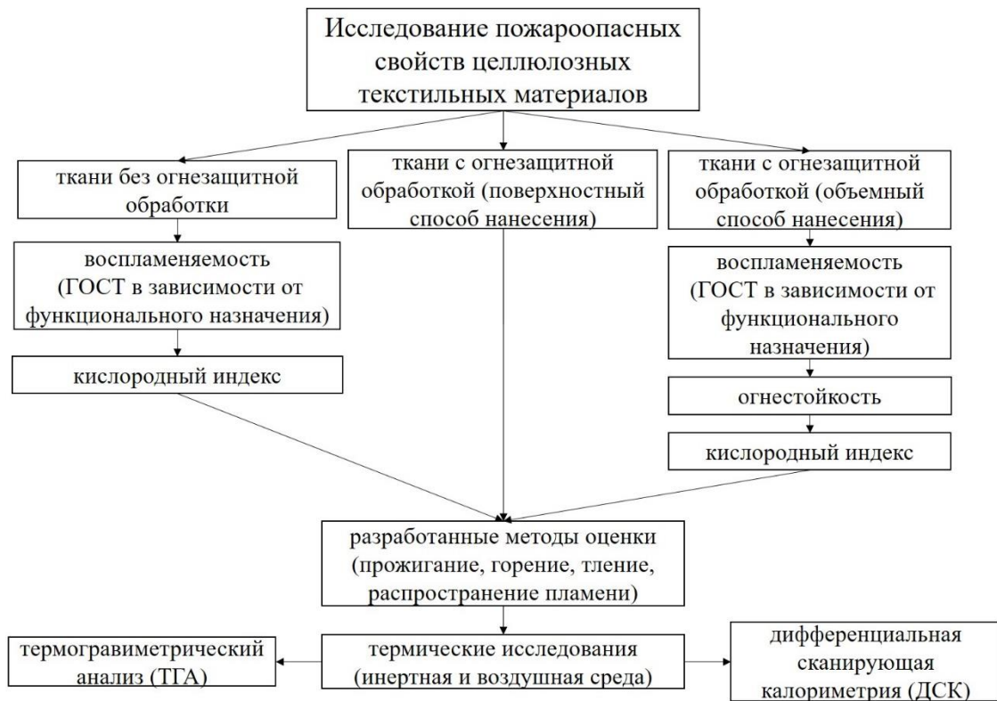
Рисунок 3.33 – Общая схема предлагаемого исследования пожароопасных свойств текстильных материалов
