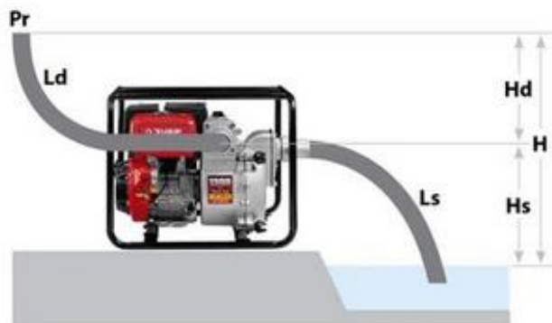
Рис. 1. Расчетные параметры при заборе воды пожарной мотопомпой с открытого водоисточника
