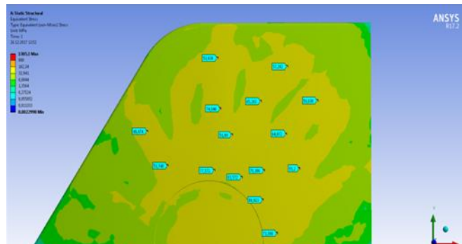
Рис. 2. Эквивалентные напряжения в обшивке, МПа. Запас прочности \eta > 2
