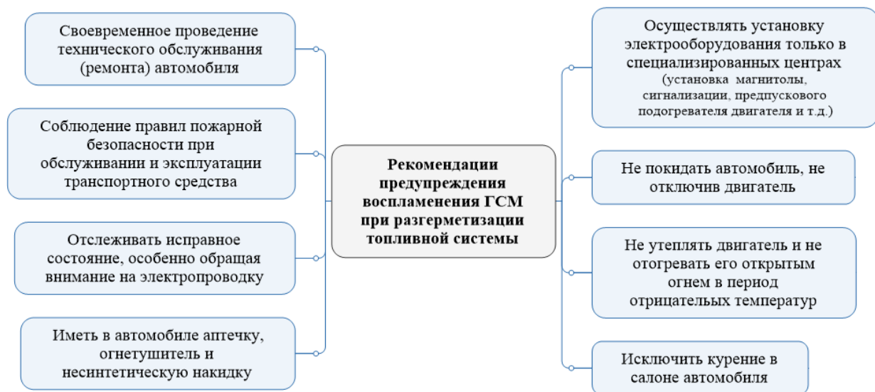
Рис. 1. Рекомендации предупреждения воспламенения ГСМ при разгерметизации топливной системы
