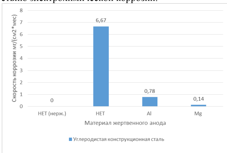
Рис. 2. График зависимости скорости коррозии от наличия и вида жертвенного анода
