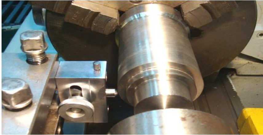
Рис. 2. Обработка детали алмазным выглаживателем
