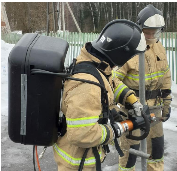
Рис. 1. Пневмогидравлический привод, совмещенный с дыхательным аппаратом
