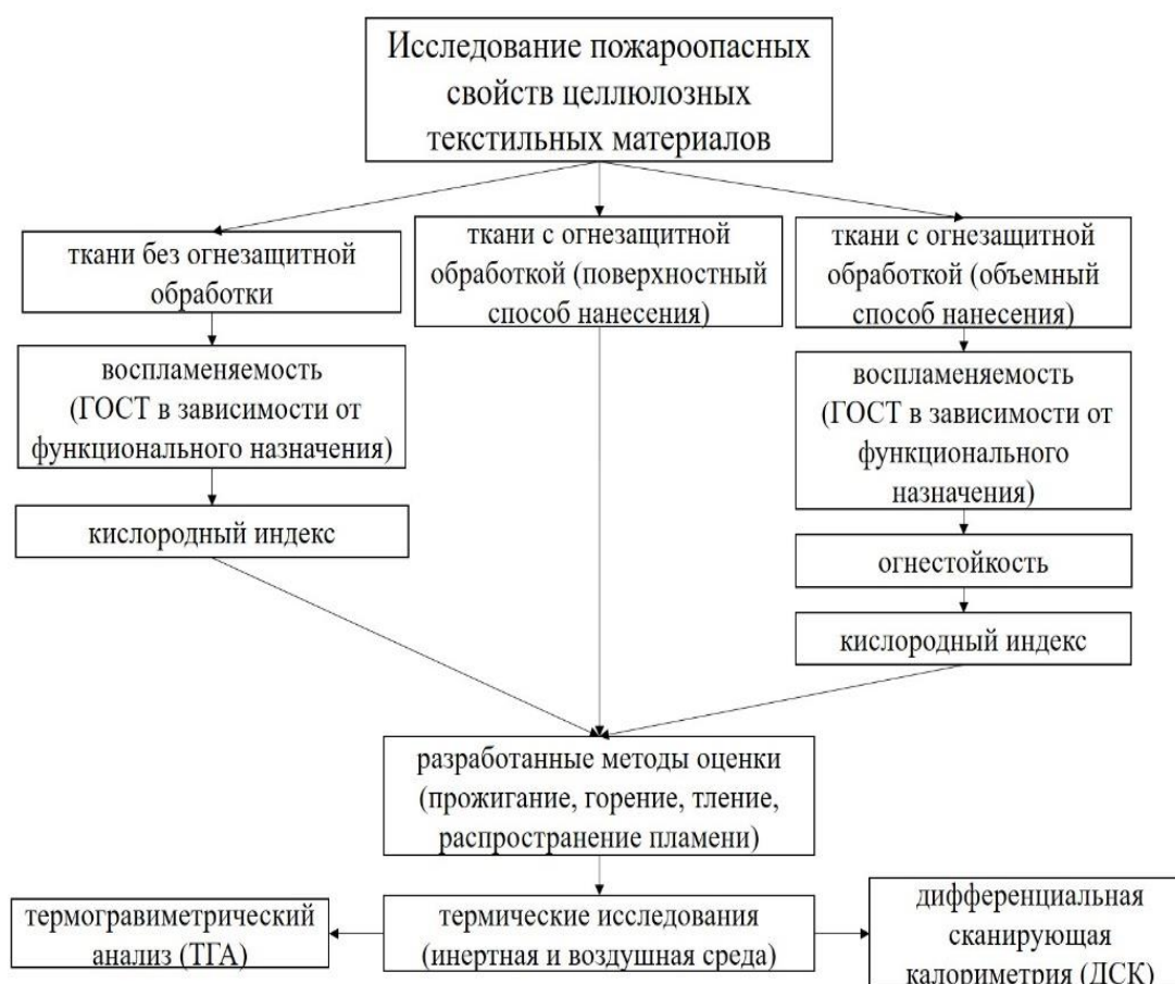
Рис. 2. Общая схема предлагаемого исследования пожароопасных свойств текстильных материалов
