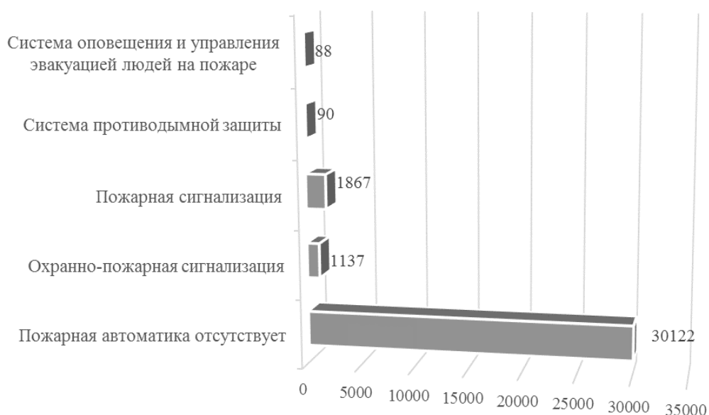
Рис. 1. Распределение крупных пожаров в городах Российской Федерации в 2010–2021 годах по различным видам пожарной автоматики на объектах защиты
