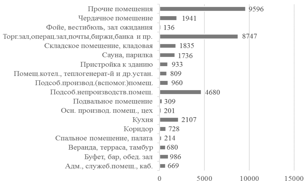
Рис. 1. Распределение пожаров по местам их возникновения на объектах торговли и сервисного обслуживания в 2011-2021 гг.
