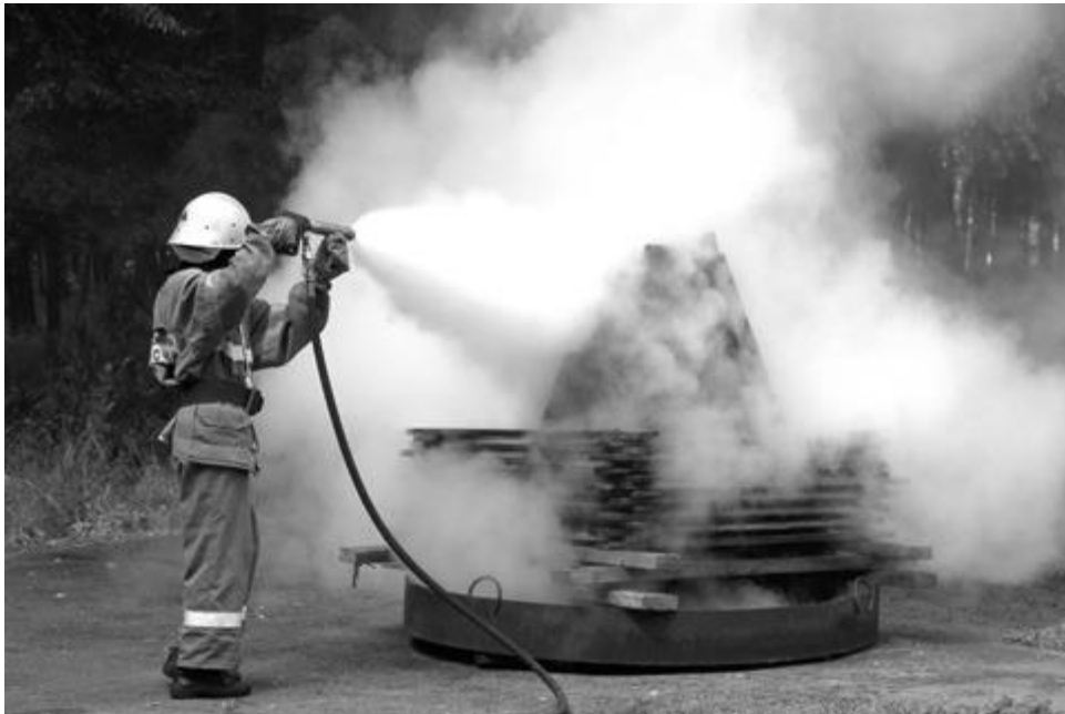
Рис. 2. Испытание технологии ТАВ при тушении экспериментального пожара
