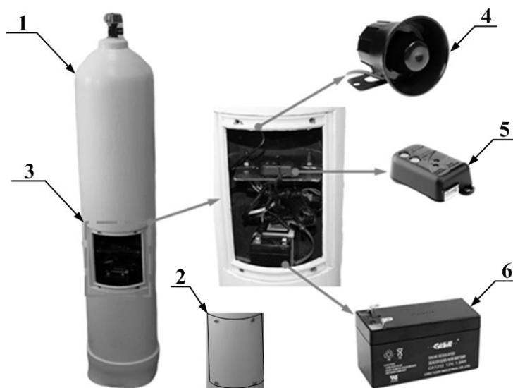
Рис. 3. Устройство тренажера «Ацетиленовый баллон»
