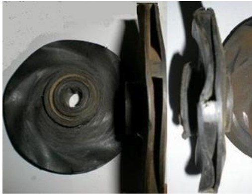
Рис.1. Деформация крыльчатки колеса насоса а)
