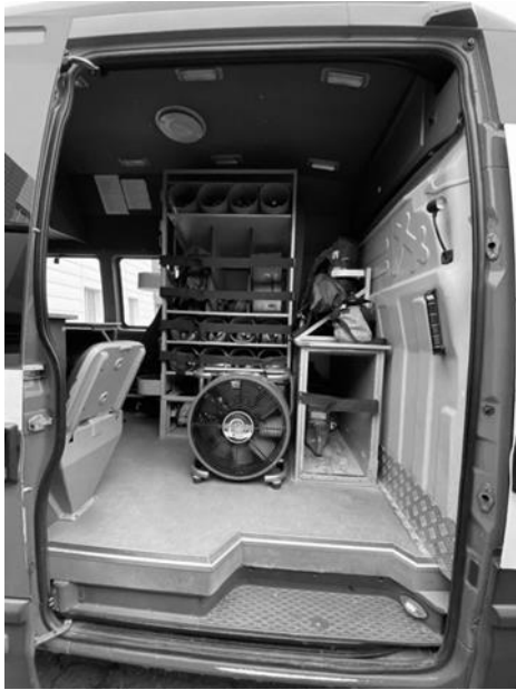
Рис. 3. АБГ-3(IVECO Daily 65C17V) внутренний отсек
