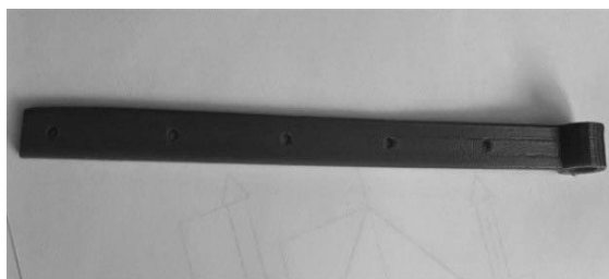
Рис. 4. Направляющая для нитей краеобметочной швейной машины 508 класса
