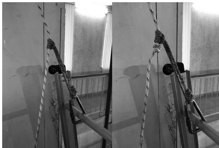
Рис. 5. Предотвращение сползания схватывающего узла
