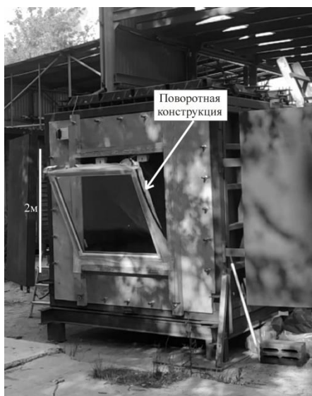
Рис.3. Фотография процесса вскрытия поворотной ПК
