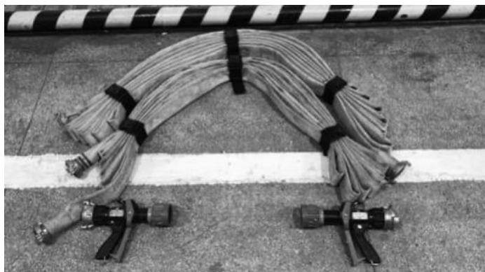
Рис. 5. 2 КУРС-8 и рукава диаметром 51 мм, уложенные «гармошкой» с использованием обвязки
