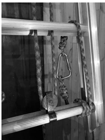
Рис. 6. Фиксация 2-го и 3-го колен лестницы страховочным усом
