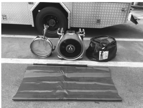
Рис.7. Оборудование для управления воздушными потоками на пожаре
