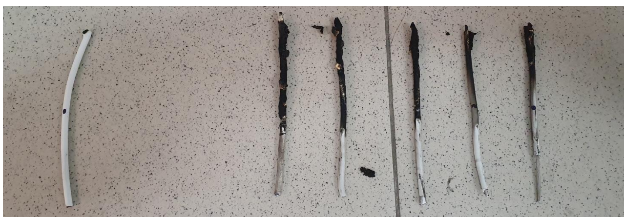
Рис. 2. Результаты испытаний образцов слева направо: 1 – воспламенение сверху (свечеобразное горение, КИ 22,6); 2-6 – воспламенение снизу (2 – КИ 22,6; 3 – КИ 22,4; 4 – КИ 22,2; 5 – КИ 22,1; 6 КИ –22,0)
