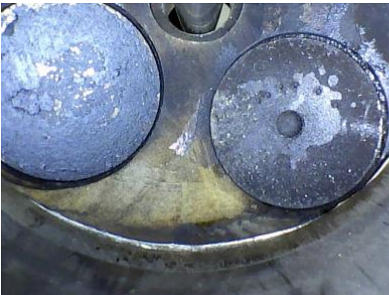
Рис. 2. Эндоскопия цилиндро-поршневой группы двигателя автомобиля
