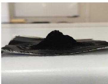
Рисунок 1 – Фотография образца «саржи», покрытого композиционным материалом с шунгитом в качестве наполнителя (образец 6), после испытаний по разработанной методике оценки интумесцентных свойств полимерных покрытий тканей специального назначения
