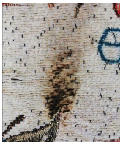
Рисунок 3.5 – Испытание на воспламеняемость образца хлопкового гобелена с обработкой раствором 2.2 АФМП + Ковелос
