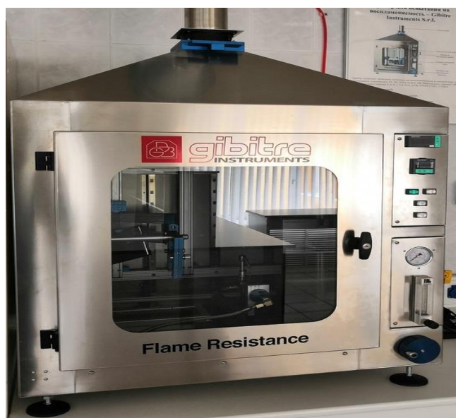
Рисунок 2.1 – Камера для испытания на горение (воспламеняемость) материалов Gibitre Flame Resistance
