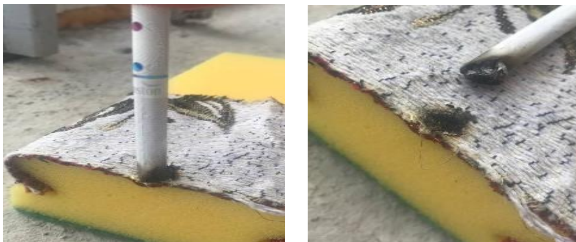
Рисунок 2.3 – Испытание образцов декоративных тканей с использованием сигаретного теста
