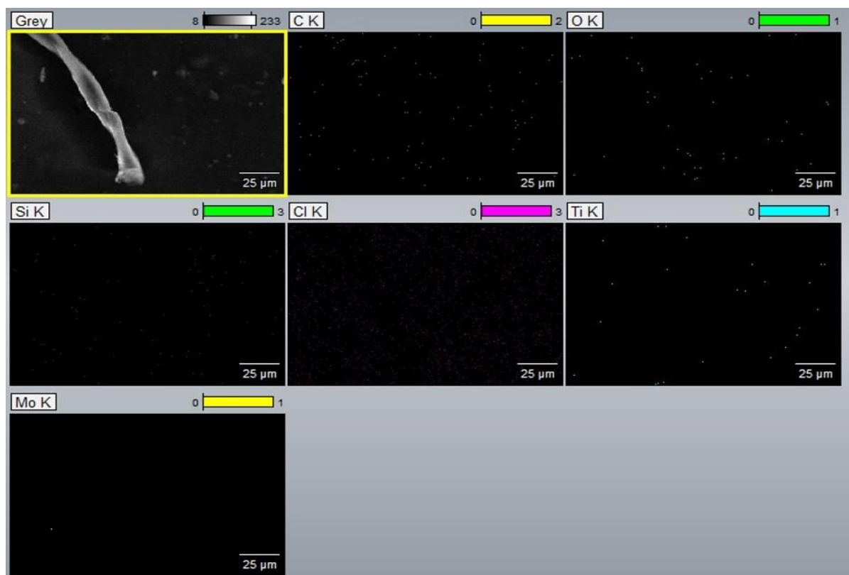
Рисунок 3.15 – СЭМ-изображение и результаты элементного картирования поверхности «брезента», покрытого композиционным материалом с диоксидом титана и шунгитом
