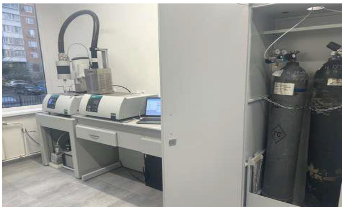
Рисунок 2.8 – Синхронный термоанализатор STA 449 F3, совмещенный с масс-спектрометром QMS 403 (NETZSCH, Германия)
