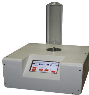
Рисунок 2.7 – Установка для определения кислородного индекса
