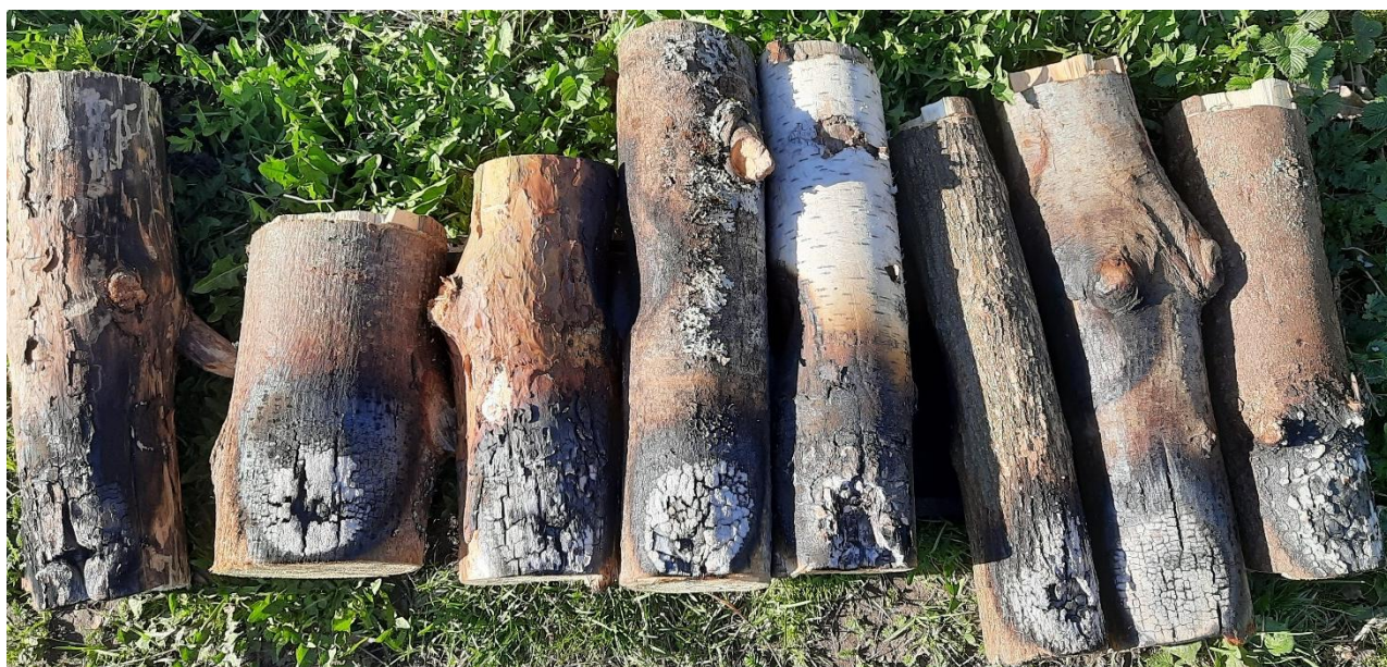
Рисунок 2.5 – Объекты выбранных пород деревьев после испытаний пламенем газовой горелки (сосна, липа, ольха, береза, осина, ель)
