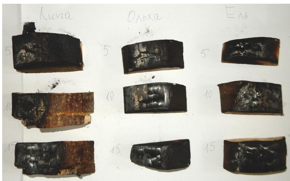
Рисунок 2.16 – Термические поражения образцов пород деревьев с низким процентом влажности
