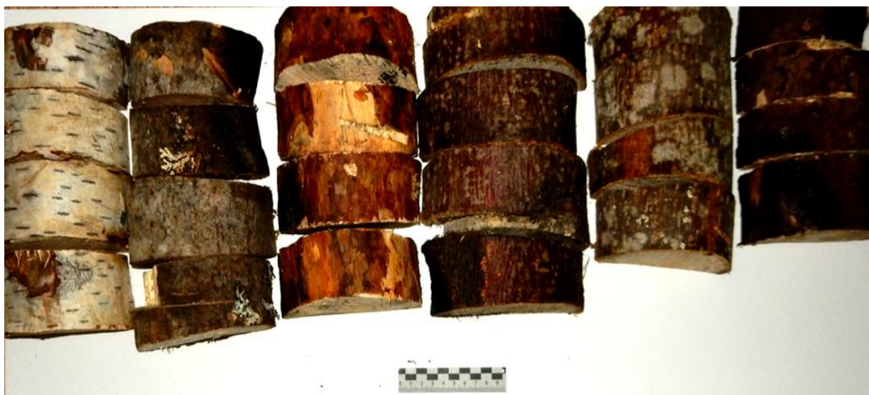
Рисунок 2.8 – Образцы различных пород деревьев, подготовленные для проведения испытаний. Слева-направо: береза, осина, сосна, липа, ольха, ель
