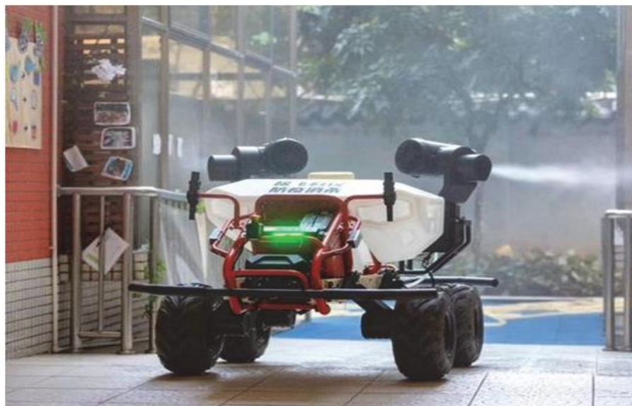
Рис. 1. Наземный робот R80 производства ХАГ распыляет дезинфицирующее средство в Китае
