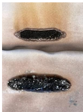
Рис. 1. Образец ткани «Энигма» после удаления ТТИ
