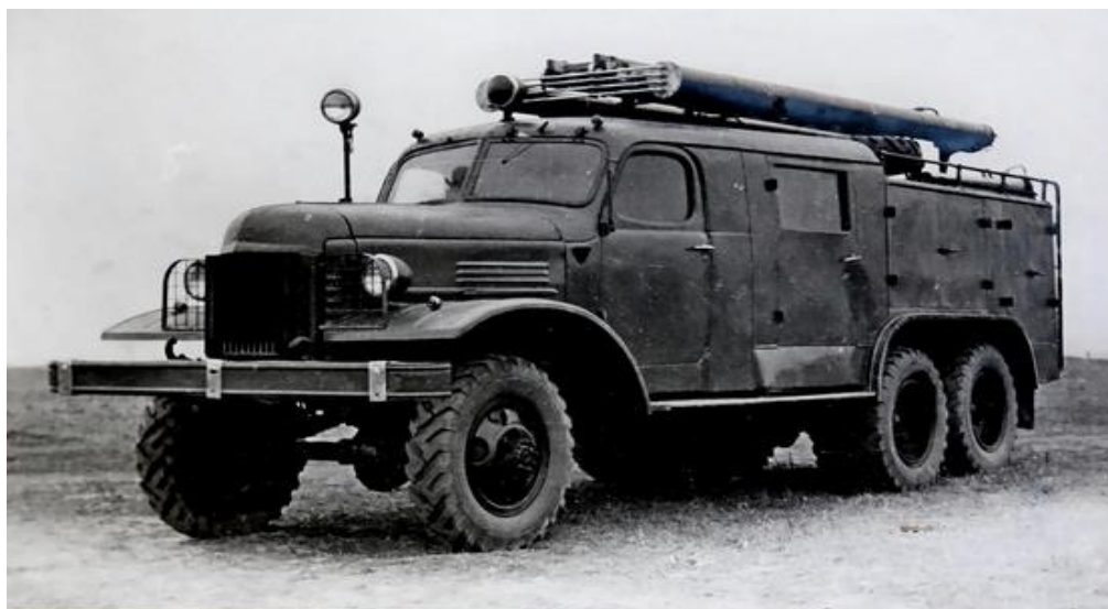
Рис. 1. Первый пожарный аэродромный автомобиль на базе ПМЗ-15
