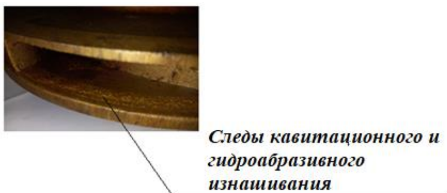
Рис. 1. Рабочее колесо пожарного насоса со следами износа
