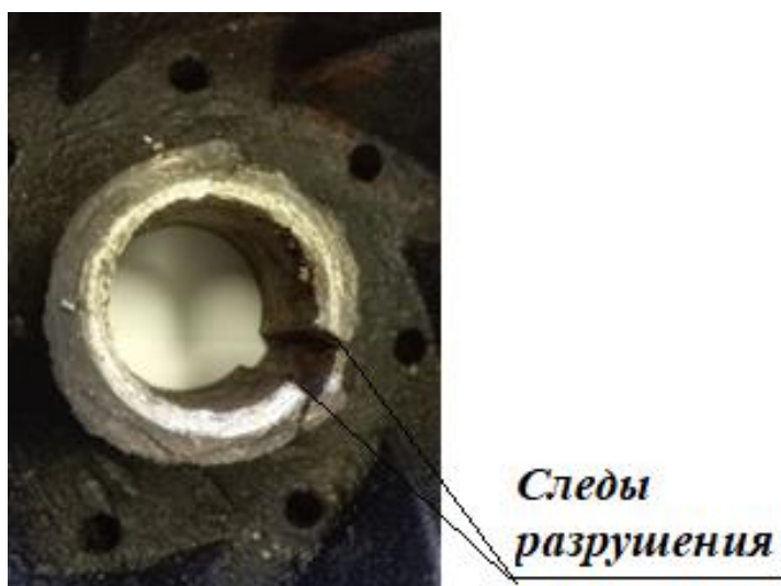
Рис. 2. Отверстие со шпоночным пазом рабочего колеса пожарного насоса ПН-40УВ
