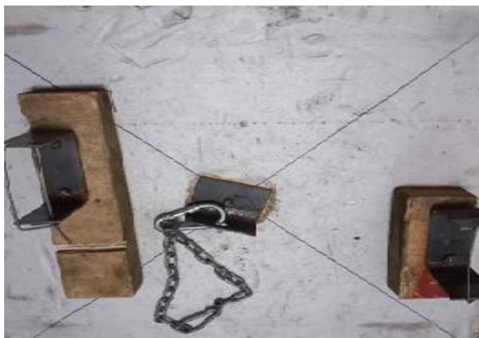
Рис. 1. Поплавок заборной сетки
