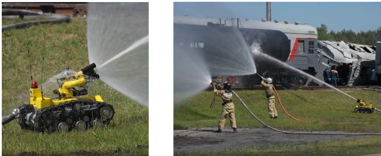
Рис. 4. Испытание огнем китайского пожарного робота (в пер. Citic RXR M40D ) на учениях МЧС России, г. Ногинск
