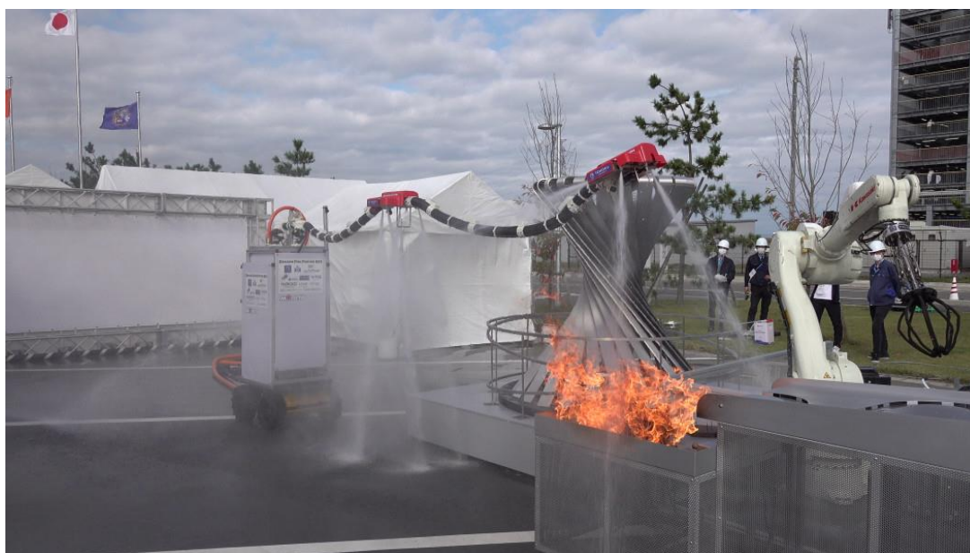
Рис. 1. Испытания робота, стоящего на страже пожарной безопасности «Летающий дракон» (в пер. Dragon Firefighter )
