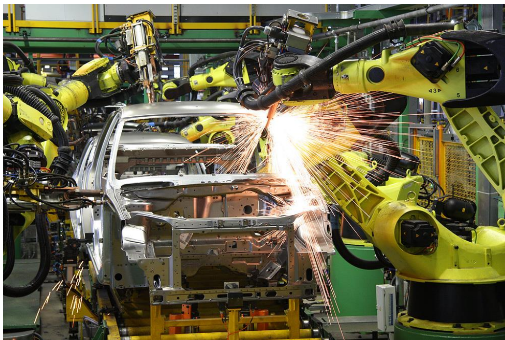
Рис. 1. Сборка автомобиля Лада на конвейере, оснащенном роботизированными установками
