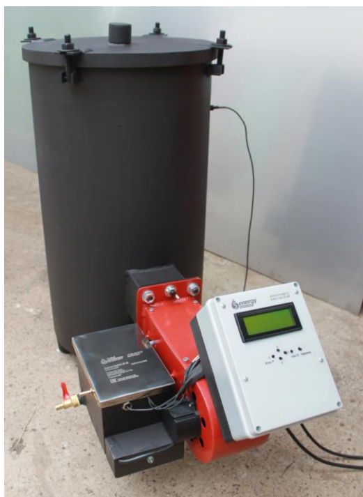
Рис. 4. Котел отопления на отработанном масле
