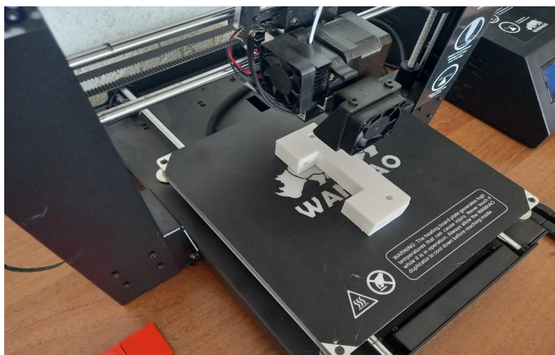
Рис.2. Печать деталей на 3D принтере WANHAO Duplicator i3 Plus
