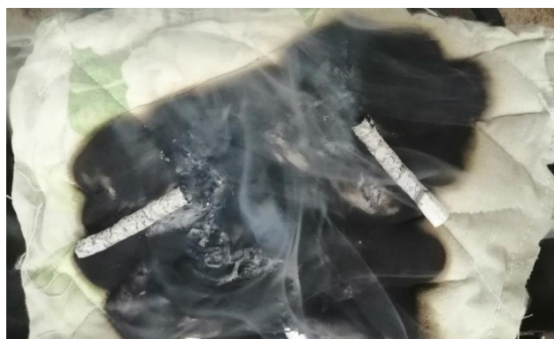
Рис. 3. Воздействие тлеющего табачного изделия на образец № 3
