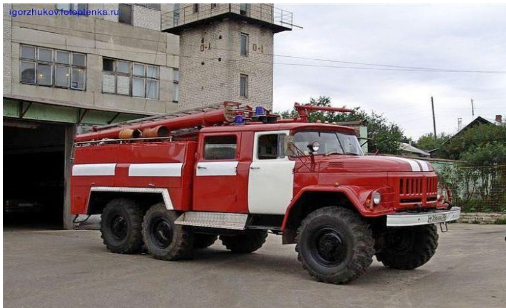
Рис. 3. АЦ-40 (131) мод. 153 с элементами «северного исполнения»
