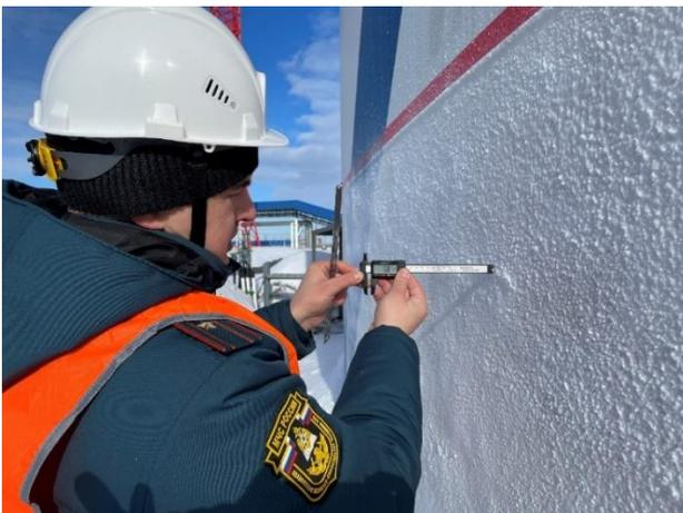
**Рис. 4.** Определение расхода гидрогеля
