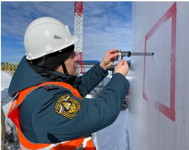
**Рис. 3.** Определение максимальной толщины покрытия
