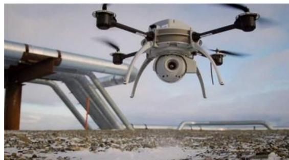
**Рис. 5.** Дрон инспектирует трубопровод в Арктике [6]
