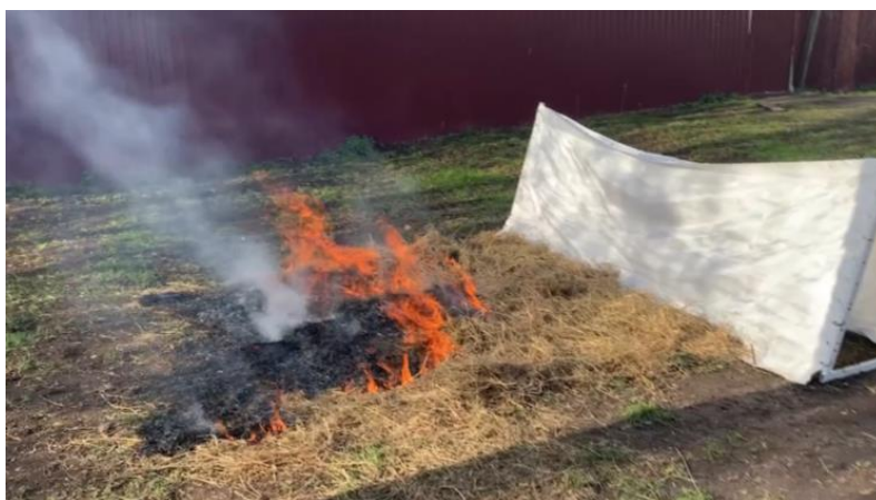
Рисунок. Испытание устройства для предотвращения распространения ЛП
