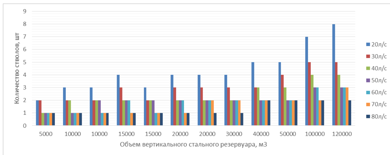
Рис. 3. Количество пожарных лафетных стволов, подаваемых от мобильных средств пожаротушения для охлаждения горящего резервуара (И.М. Абдурагимов, Т.И. Абдурагимова)
