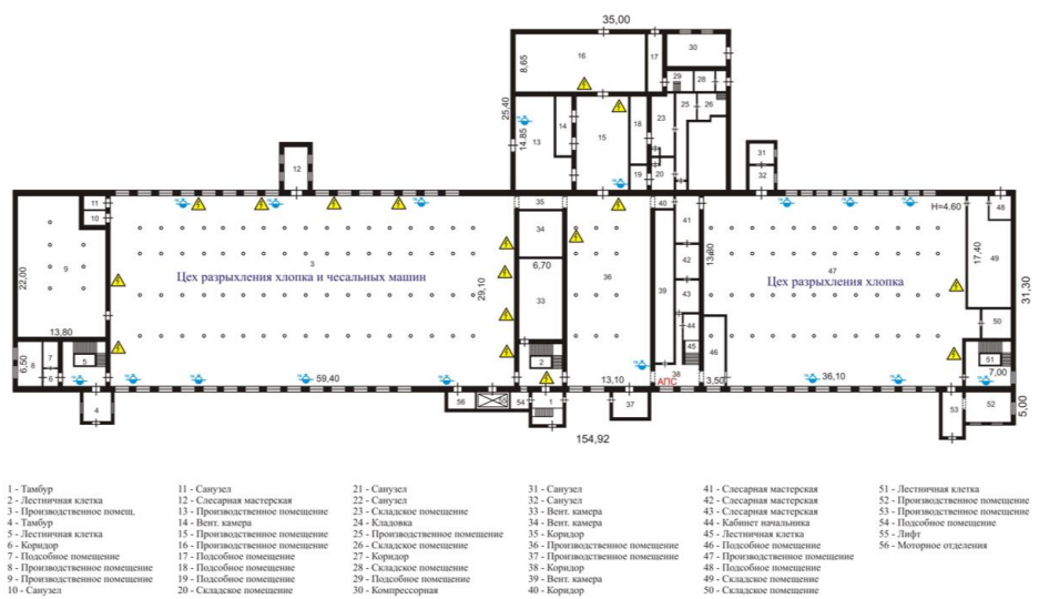
Рис.2. Схема производственного цеха с указанием источников возможного возникновения электрической искры
