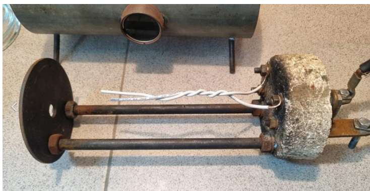
Рис. 1. Фиксация медных проводников для моделирования короткого замыкания
