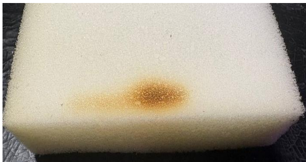
Рис. 1. Фотография результатов испытания образца с огнезащитной обработкой
