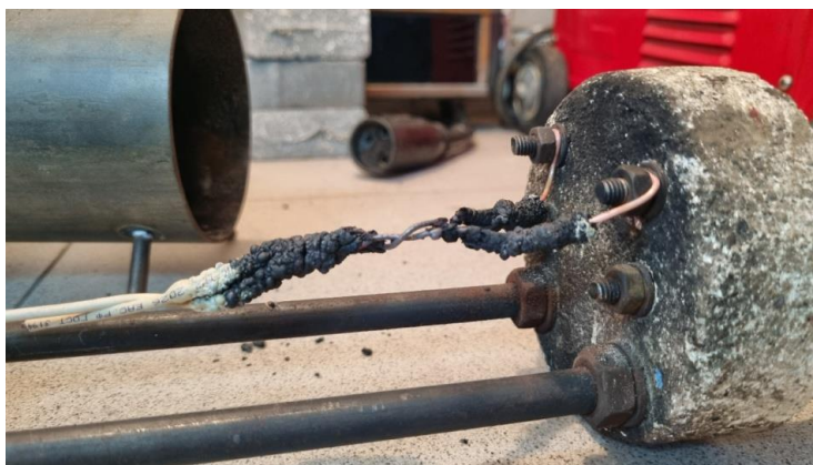
Рис. 3. Внешний вид медного проводника после моделирования короткого замыкания
