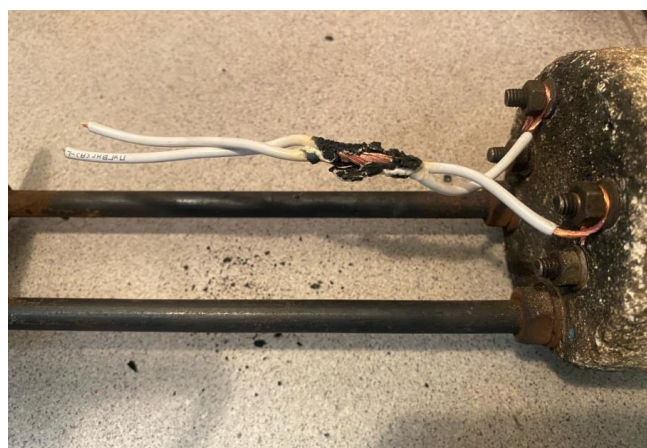
Рис. 2. Образец многожильного провода после моделирования короткого замыкания
