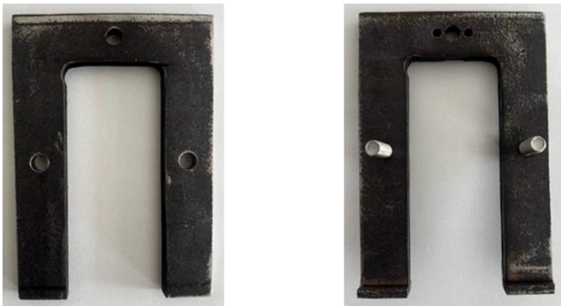
Рис. 3. Внешний вид рамки-держателя: а) прижимная пластина, б) основание
