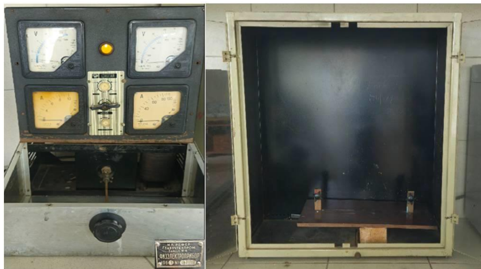
Рис. 1. Установка для исследования токовых перегрузок
