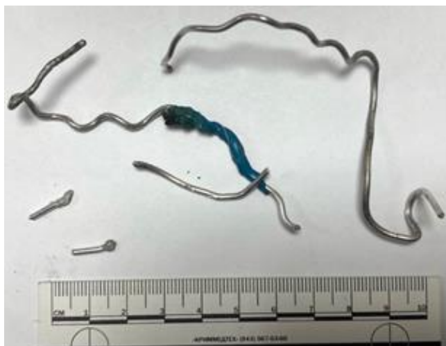
Рис. 3. Образцы алюминиевых проводников после моделирования аварийных режимов работы
