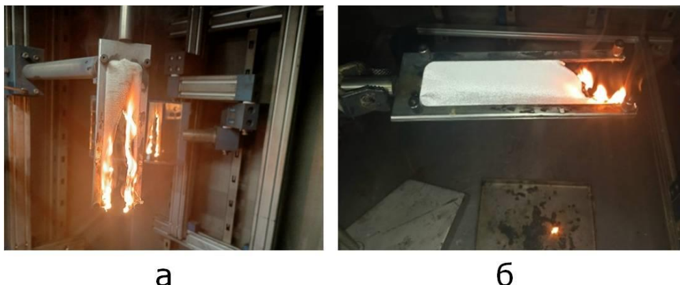
Рис. 3. Образцы тканей «вельбоа длинноворсовый» (образец № 4) при определении вертикальной скорости распространения пламени (а) и «бархат» (образец № 3) при определении горизонтальной скорости распространения пламени (б)
