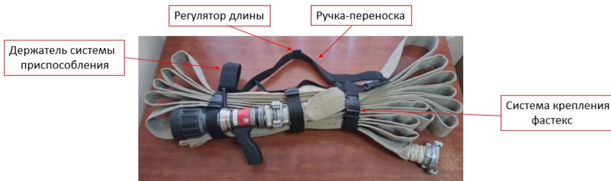
Рис. 5. Внешний вид изготовленного приспособления для транспортировки напорных пожарных рукавов (2 ед.) скаткой «гармошка» со стволом
