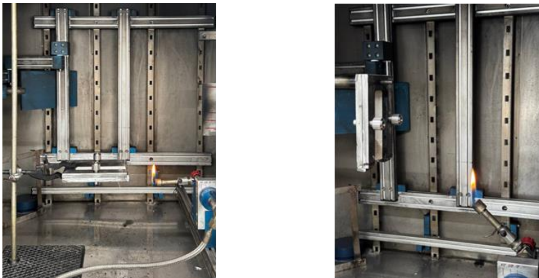
Рис. 5. Рамка-держатель с исследуемым образцом, установленная в горизонтальном и вертикальном положении
