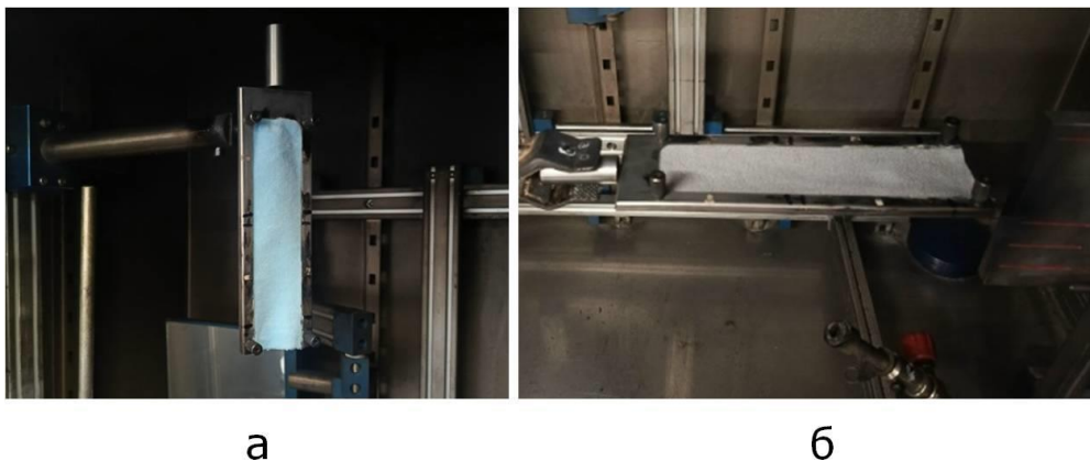
Рис. 2. Исходные образцы тканей «плюш Минки» (образец № 2) для определения вертикальной скорости распространения пламени (а) и «флис» (образец № 1) для определения горизонтальной скорости распространения пламени (б)
