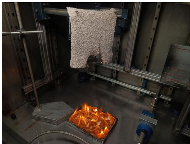
Рис. 1. Испытание ткани «букле» (образец № 5) на воспламеняемость
