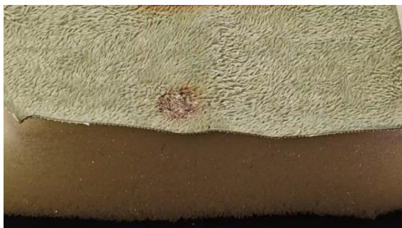
Рис. 1. Фотография результатов испытания образца с огнезащитной обработкой
