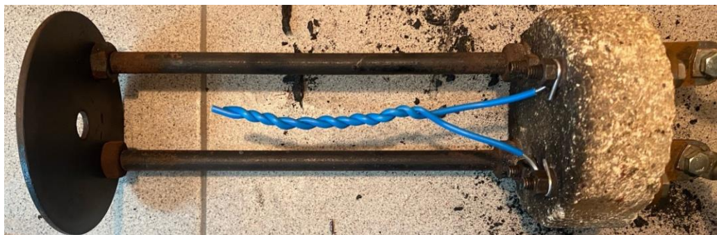
Рис. 2. Фиксация алюминиевых проводников для моделирования короткого замыкания
