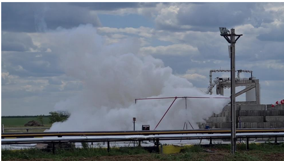
Рис. 4. Ликвидация пламенного горения, 2 с после начала выхода ГПОВ.
