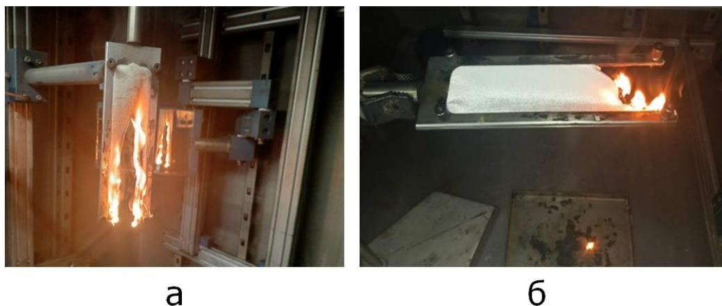
Рисунок. Образцы тканей «вельбоа длинноворсовый» при определении вертикальной скорости распространения пламени (а) и «бархат» при определении горизонтальной скорости распространения пламени (б)
