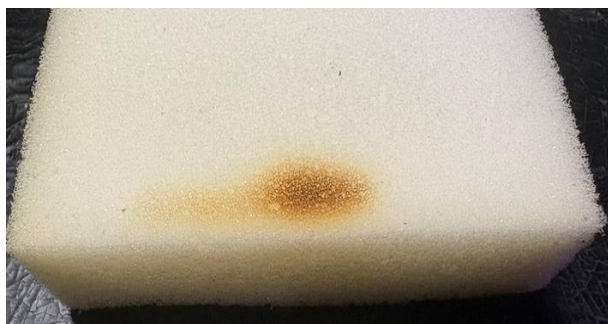
Рисунок. Фотография результатов испытания образца с огнезащитной обработкой
