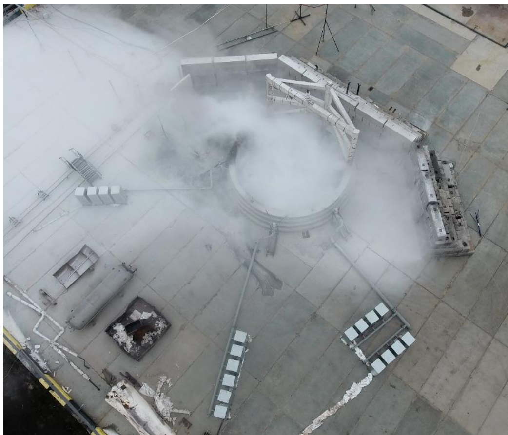
Рис. 13. Ликвидация возгорания пролива СПГ, 1 мин.
