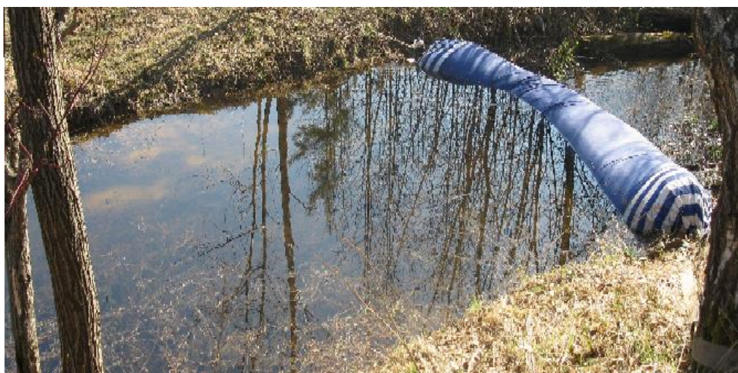
Рис. 1. Опытный образец ГТС из тканевого рукава с полиэтиленовым вкладышем
