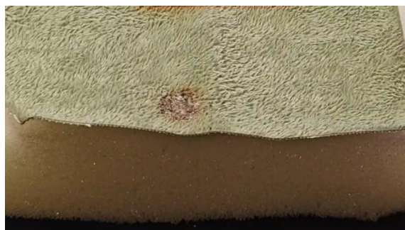
Рисунок. Фотография результатов испытания образца с огнезащитной обработкой
