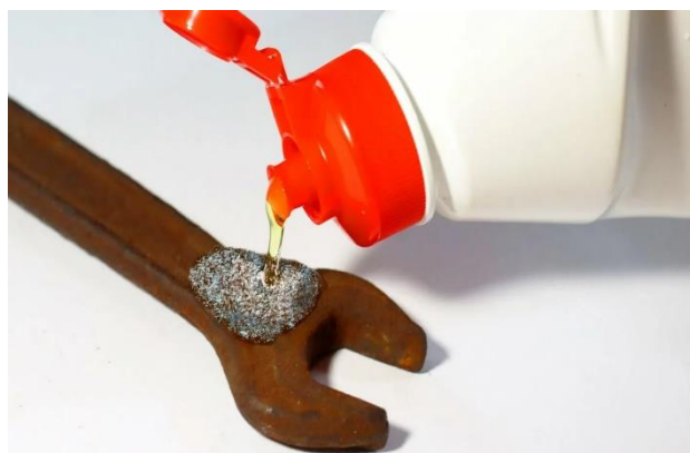
Рис. 3. Способы удаления продуктов коррозии: а – механический способ; б – химический способ.
