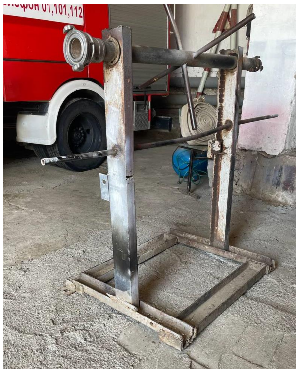
Рис. 2. Разработанное приспособление (станок) для навязки и перекатки пожарных рукавов
