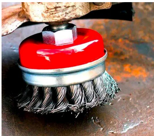
Рис. 3. Способы удаления продуктов коррозии: а – механический способ; б – химический способ.
