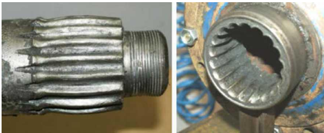
Рис. 5. Износ при фреттинге деталей шлицевого соединения
