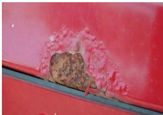
Рис. 2. Элемент кабины автомобиля со следами коррозии
