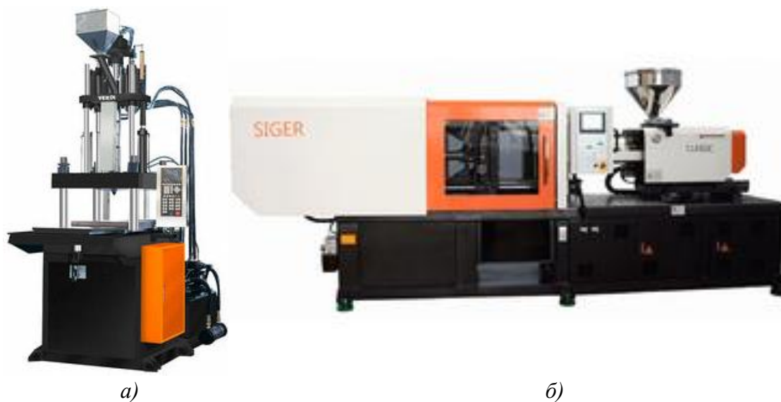
Рис. 1. Термопластавтоматы со шнековой пластикацией: а – вертикальный; б – горизонтальный
