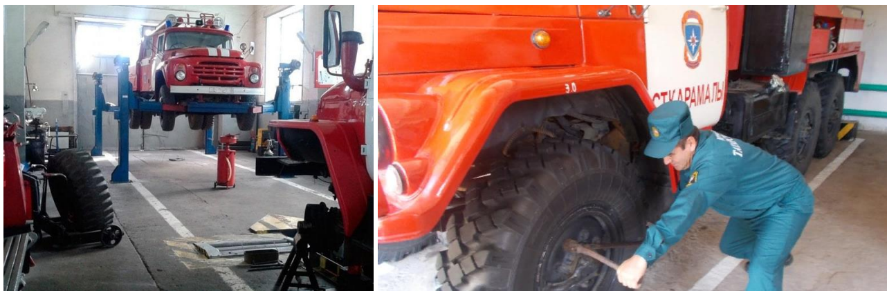
Рис. 1. Проведение регламентных работ на посту ТО
