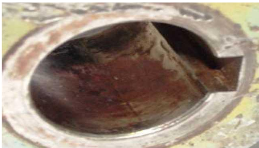
Рис. 6. Фреттинг-коррозии втулки шлицевого соединения
