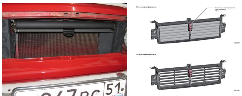
Рис. 3. Пример исполнения дополнительных шторок и жалюзи на фронте радиатора
