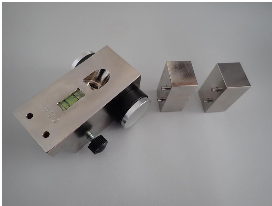
Рис. 1. Внешний вид прибора НТ-6510Р для определения свойств лакокрасочного покрытия
