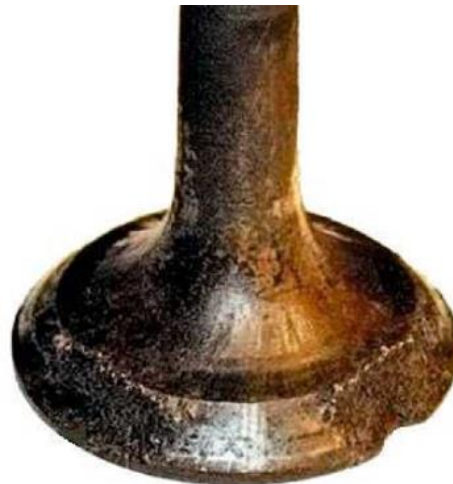
Рис. 2. Эрозионный износ клапана газораспределительного механизма двигателя
