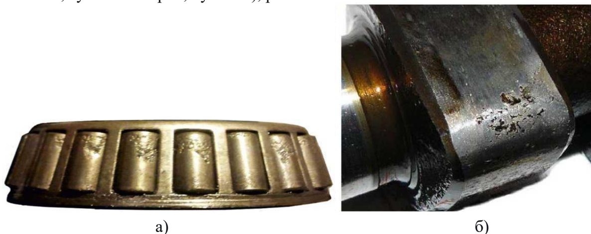
Рис. 4. Усталостный износ: а – роликов подшипника; б – кулачка распределителя
