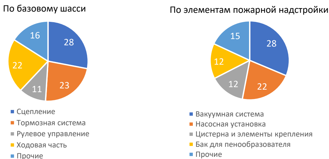
Рис. 2. Поэлементный перечень отказов пожарных автомобилей ГУ МЧС России по Республике Северная Осетия-Алания за 2025 год
