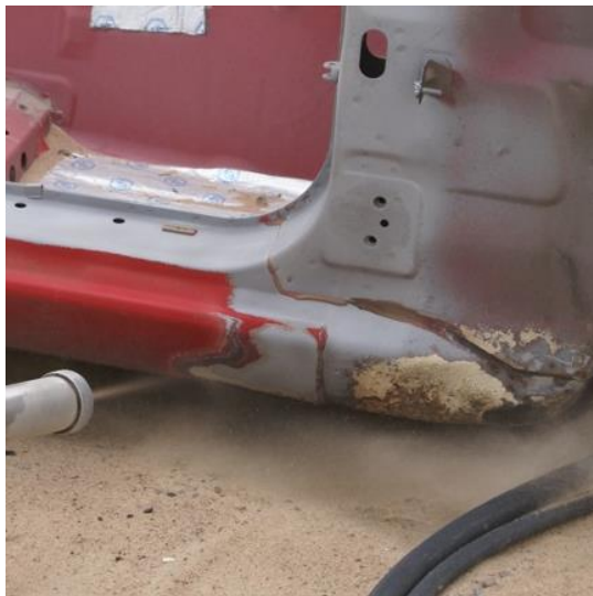
Рис. 4. Пескоструйная обработка кузовных деталей автомобиля.
