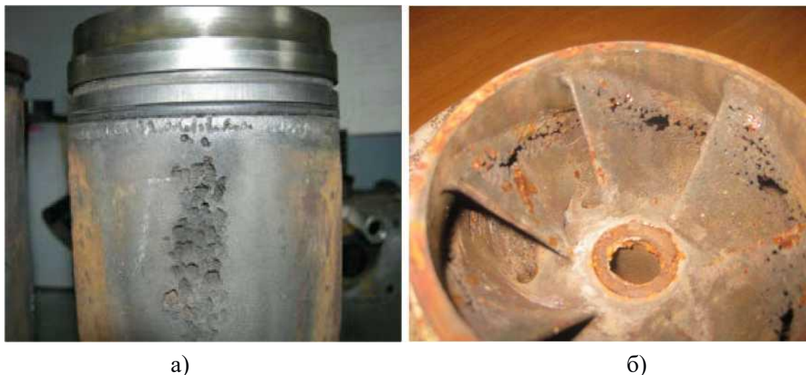
Рис. 3. Кавитационный износ: а - гильзы цилиндра двигателя с наружной стороны; б – крыльчатки водяного насоса
