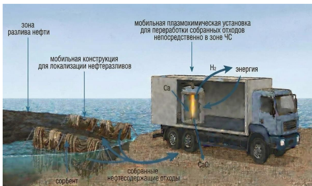
Рис. 2. Концептуальная схема функционирования подвижного комплекса локализации и переработки ННП
