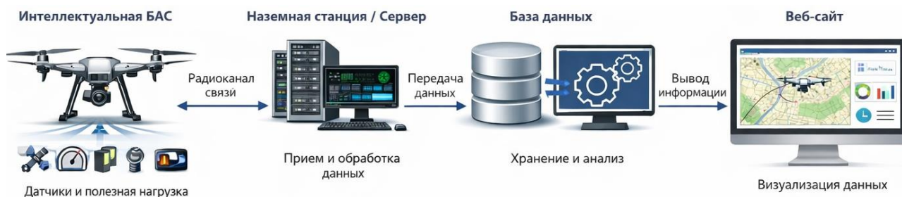
Рисунок. Архитектура передачи телеметрических данных с интеллектуальной БАС на веб-сайт
