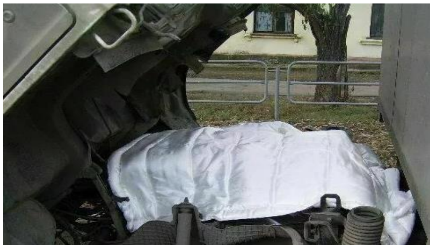
Рис. 2. Применение автоодеяла для двигателя автомобиля
