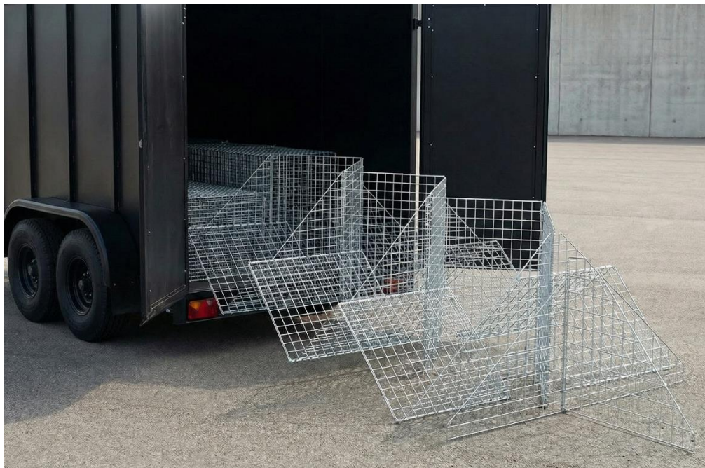
Рис. 1. Мобильный прицеп со средством локализации и сбора ННП
