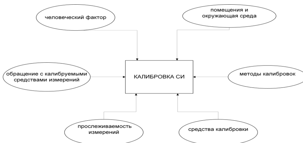
Рис. 3. Факторы, влияющие на качество калибровки многофункционального калибратора Fluke 5502E
