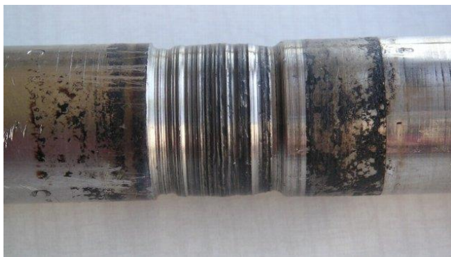
Рис. 1. Вал насоса со следами абразивного износа
