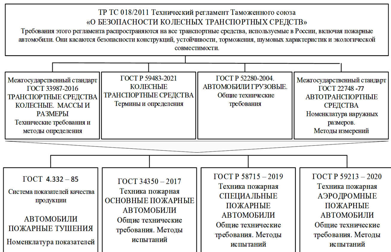
Рисунок. Система основных технических нормативных правовых актов, определяющих технические требования к базовому шасси пожарных автомобилей
