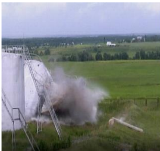
Рис. 3. Кадры видеосъемки разрушения РВС-700 м 3 с водой, образования волны и ее перелива через обвалование при проведении натурного эксперимента
