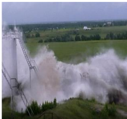
Рис. 3. Кадры видеосъемки разрушения РВС-700 м 3 с водой, образования волны и ее перелива через обвалование при проведении натурного эксперимента
