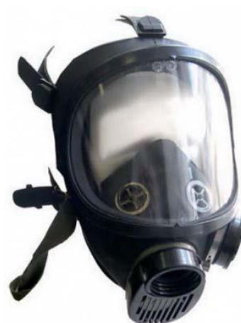
в) Панорамная маска с утраченным оптическим свойством
