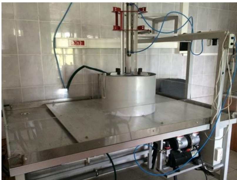
Рис. 4. Общий вид лабораторного стенда с модельным резервуаром типа «стакан в стакане»
