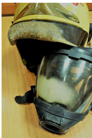
а) Панорамная маска после термического воздействия
