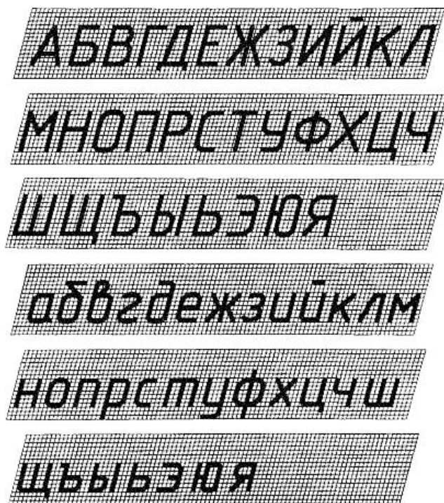
Рисунок 1.4 – Шрифт типа Б с наклоном
