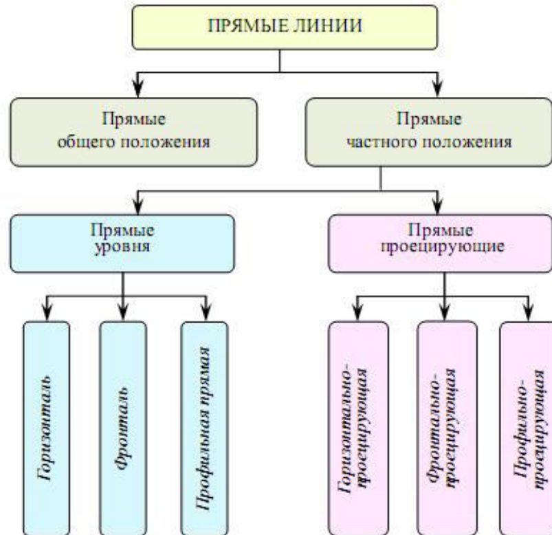
Рисунок 1.4 – Классификация прямых по положению относительно плоскостей проекций
