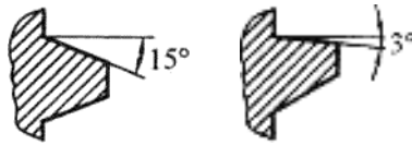
Рис.2.20 Виды сечений витка резьбы.
