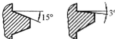
Рис.9.20 Виды сечений витка резьбы.
