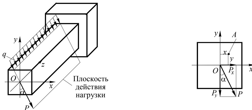
Рис. 4.6. Косой изгиб и вычисление нормальных напряжений
